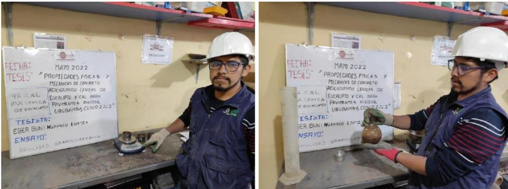
**Fotografia 3 Y Fotografia 4: IZQUIERDA: Determinación del contenido de humedad, DERECHA: Determinación del peso específico.**
