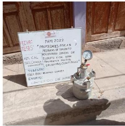
Fotografía 1 y Fotografía 2 Determinación del contenido de aire del concreto (Patrón Y Patrón + 4% de ceniza + 12% de cal).
