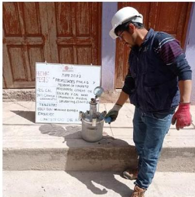
Fotografía 3 y Fotografía 4 Determinación del contenido de aire del concreto (Patrón + 4% de ceniza + 10% de cal)
