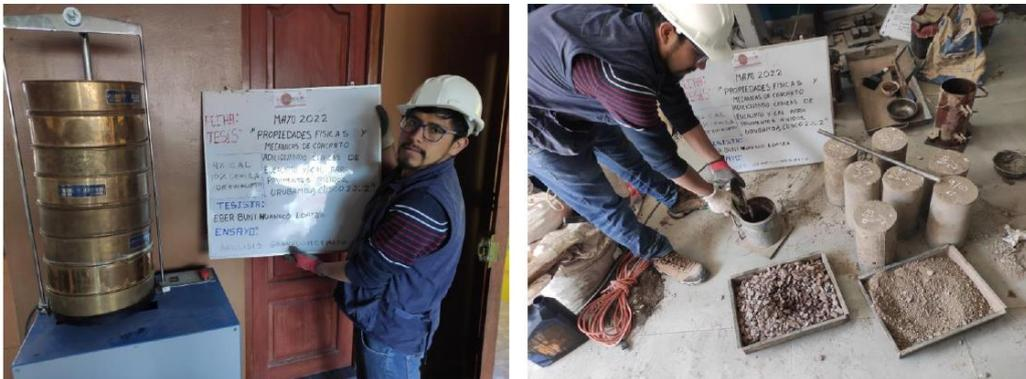
Fotografía 5 Y Fotografía 6 Análisis granulométrico y peso unitario.
