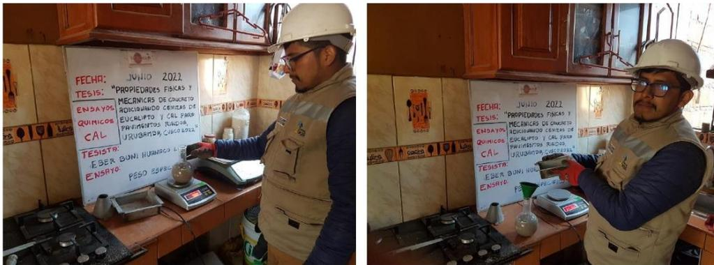
Fotografía 3 y Fotografía 4: Determinación del peso específico.
