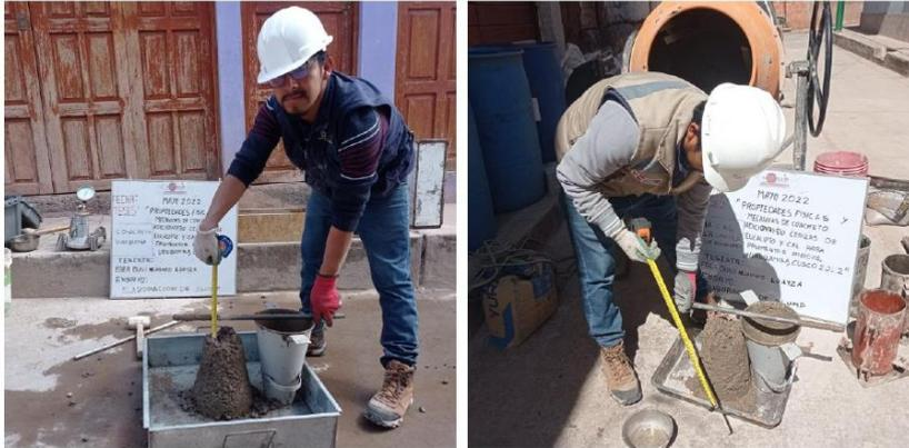
Fotografía 1 y Fotografía 2 Determinación del SLUMP.
