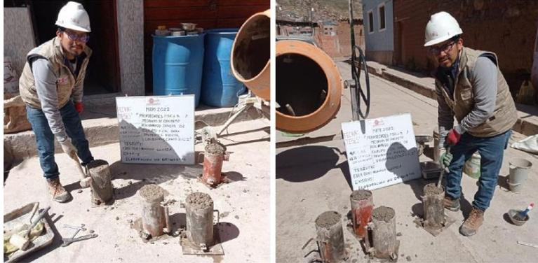
**Fotografía 9 Y Fotografía 10: IZQUIERDA: Elaboración de briquetas.**
