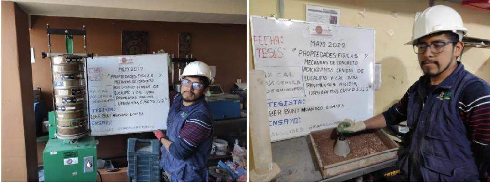
**Fotografia 1 Y Fotografia 2 IZQUIERDA: Lavado de muestras para análisis granulométrico, DERECHA: Determinación de la absorción del agregado.**
