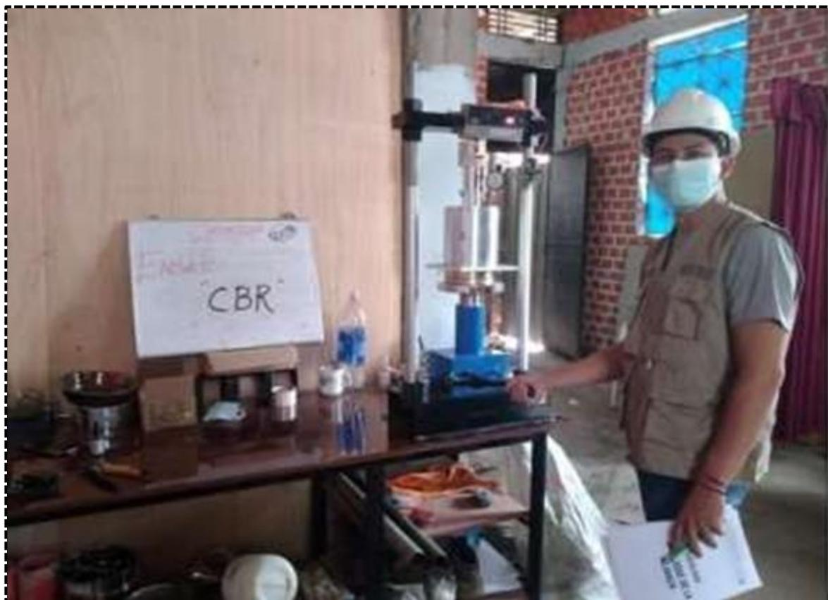
Fotografía 04: Ensayo de CBR
