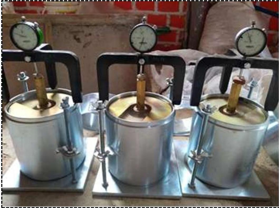
Fotografía 03: Muestra para el Ensayo de CBR
