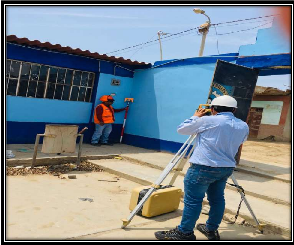
Foto N° 03. EL PRISMERO UBICADO EN PUNTO GEODESICO PARA INICIAR EL LEVANTAMIENTO TOPOGRAFICO DE APOYO
