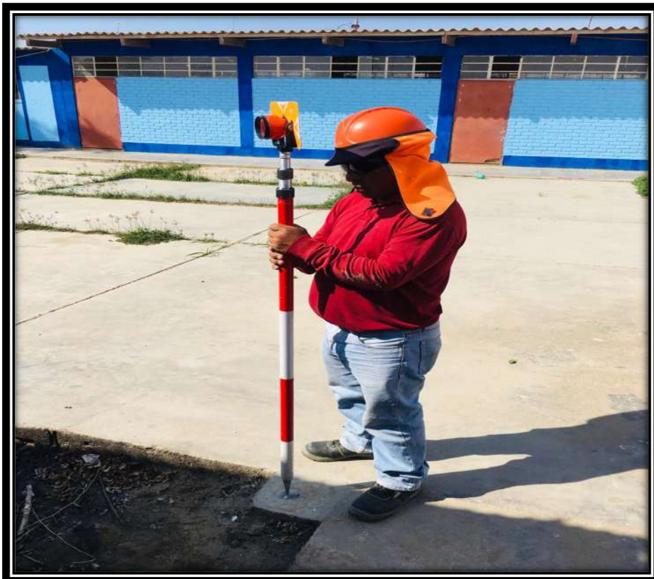
Foto N° 03. EL PRISMERO UBICADO EN PUNTO GEODESICO PARA INICIAR EL LEVANTAMIENTO TOPOGRAFICO DE APOYO
