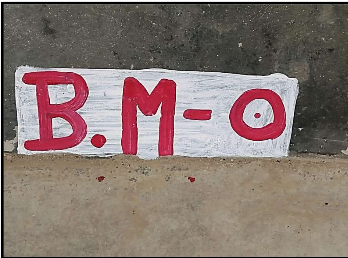
Foto N° 06. Bench Mark, se encuentra ubicado cerca al área de la I.E. en una vereda de concreto como se puede observar en la foto.
