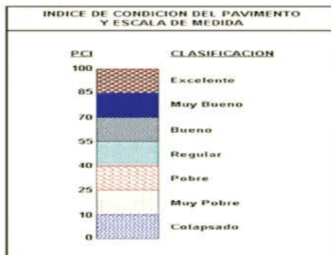
Figura 1 Escala de medida del índice de condición del pavimento PCI
