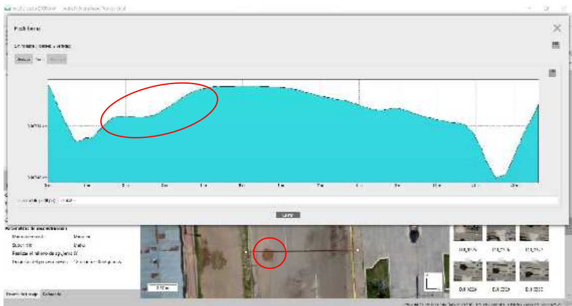
Figura 28 Corte transversal de la plataforma izquierda Av. los Proceres con presencia de falla.
