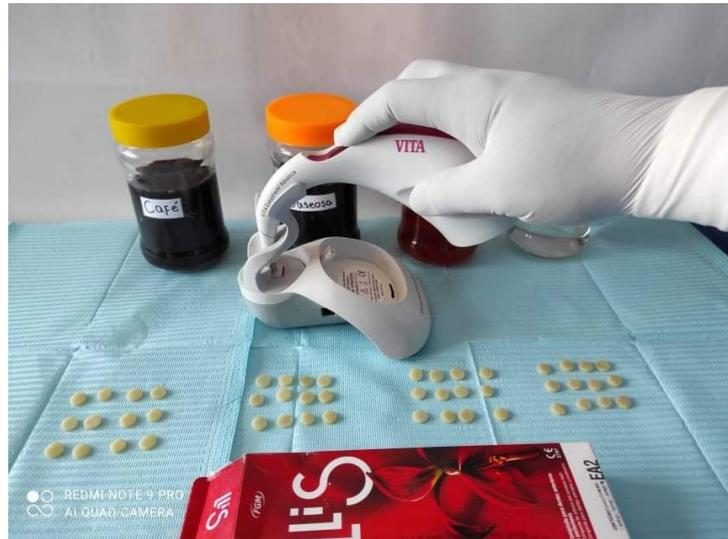
Calibración del espectrofotómetro
