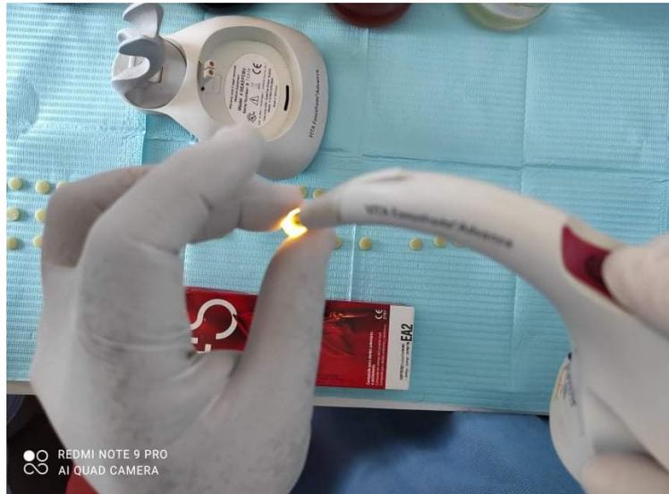
Toma inicial de los discos de resina con el espectrofotómetro
