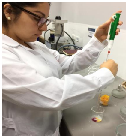
Figura 3. Determinación de acidez titulable.
