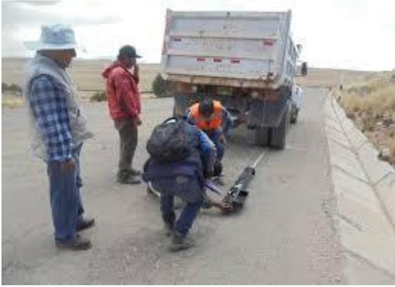
Figura: 3.9 ensayos realizados con la viga benkelman
