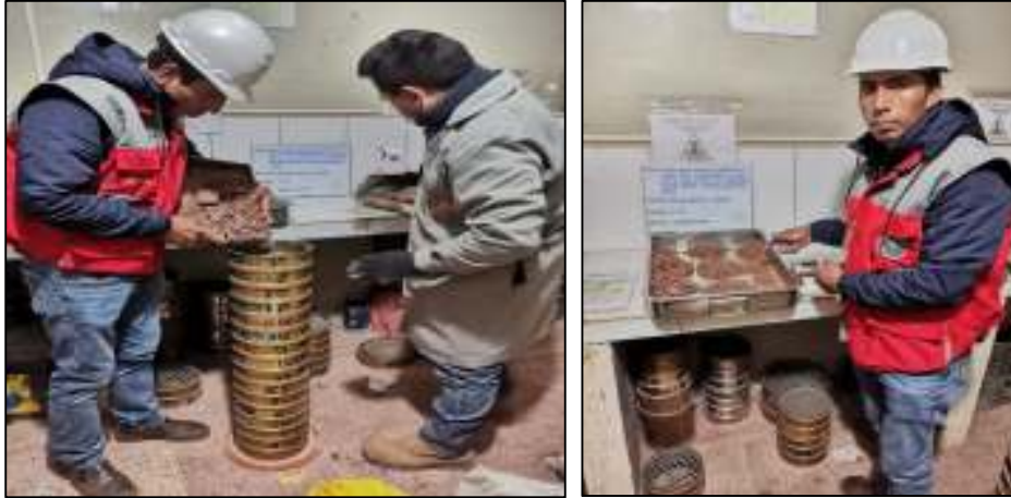
Figura 21. Procedimiento de ensayo de granulometría
