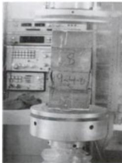
Figura 10. Ensayo de Pilas ensayados a rotura por compresión I (CASABONE, 2005)
