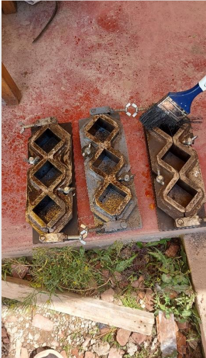
Figura 39.-preparando los moldes metálicos para colocar la mezcla de mortero
