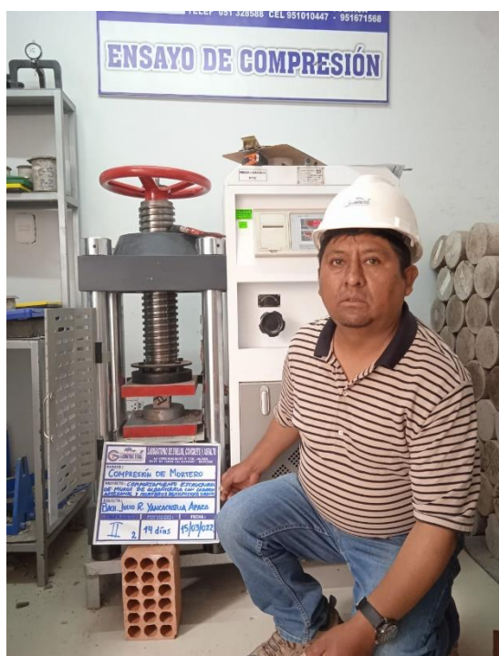
Figura 59: Ensayo de compresión del mortero
