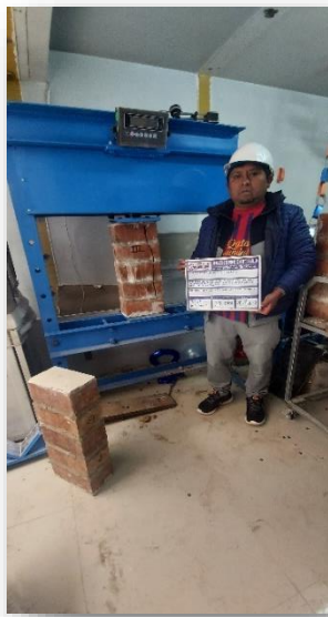
Figura 62.- ensayo compresión axial en pilas a los 14 días
