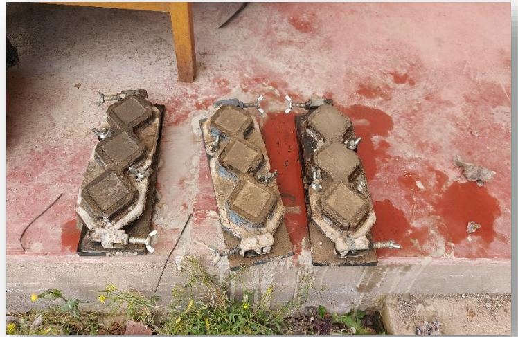
Figura 40.- moldes de metal con mortero de 2"x2"
