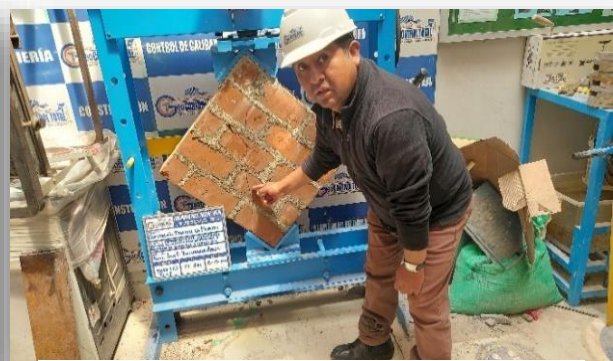
Figura 65.- Tipo de rotura unidad de albañilería y mortero
