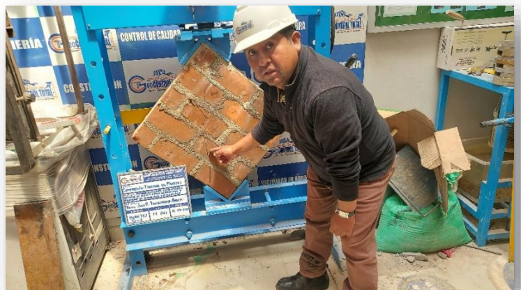
Figura 41.- ensayo de compresión diagonal de muretes de albañilería
