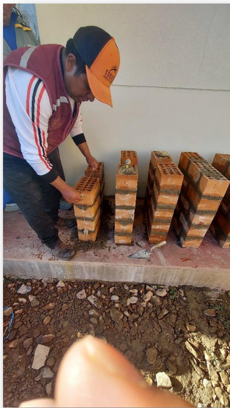
Figura 33.- elaboración de pilas o prismas de albañilería
