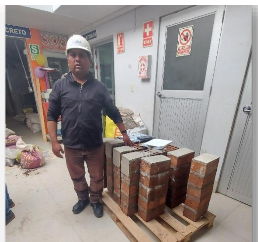
Figura 34.- Pilas y muretes previa a su rotura a los 14 días
