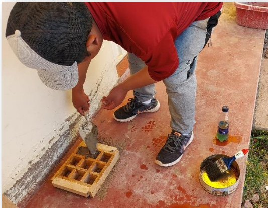
Figura 38.- elaboración de cubos de mortero de 2"x2" para ensayos de compresión
