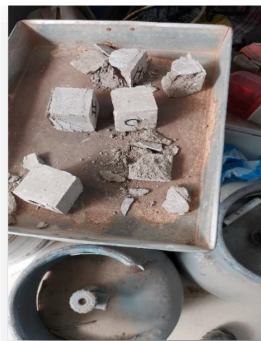
Figura 51.- probetas ya rotas luego de realizado el ensayo
