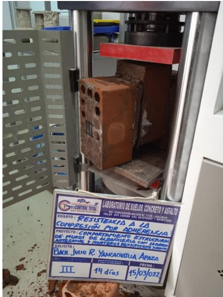
Figura 68.-Ensayo de adherencia por tracción a los 14 días.
