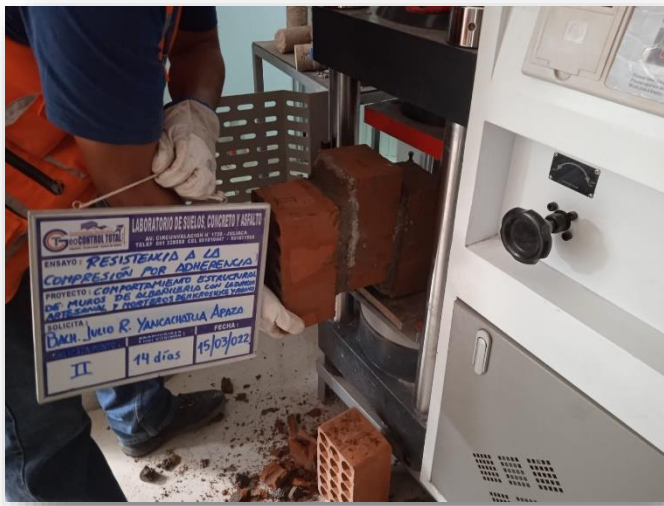
Figura 54.- ensayo de resistencia a compresión por adherencia
