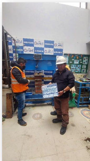
Figura 46.- ensayo de compresión axial en pilas de albañilería
