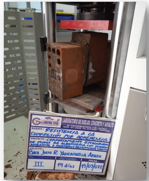
Figura 53.- iniciando el otro ensayo de compresión por adherencia dosificación III
