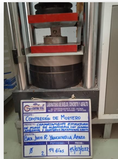
Figura 50.-Maquina de compresión para ensayo de mortero D0 espécimen 2
