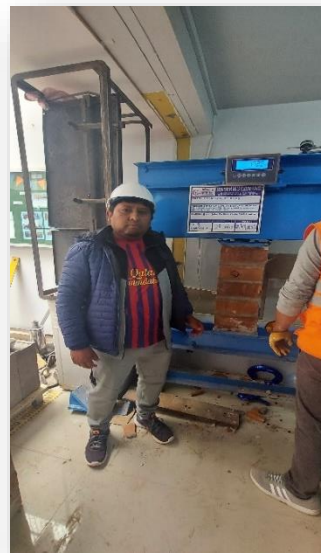
Figura 61.- ensayo a compresión axial en pilas a los 28 días
