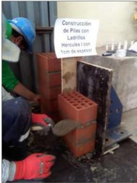
Figura 9: Pilas con Ladrillos Hércules I con 1 cm de espesor (ARBILDO HUAMANÍ, y otros, 2017)
