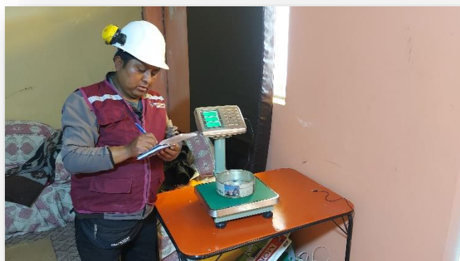
Figura 25.- realizando el peso de microsilíce en proporción con el peso del cemento
