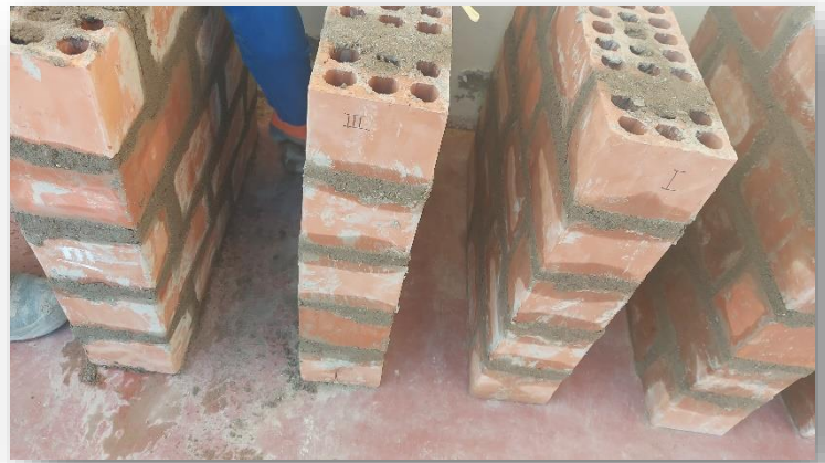
Figura 31.- Muretes ya terminados en proceso de fraguado y curado
