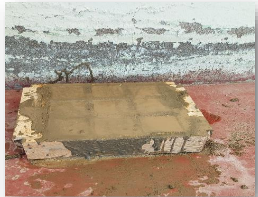
Figura 37.- cubos de concreto en su molde ya enrasados
