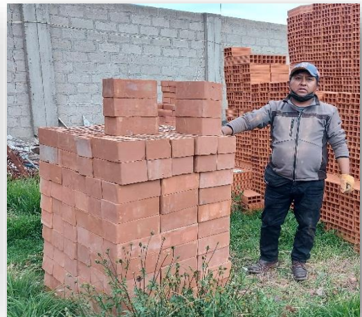
Figura 16.- Acopio de Unidades de Albañilería Artesanal
