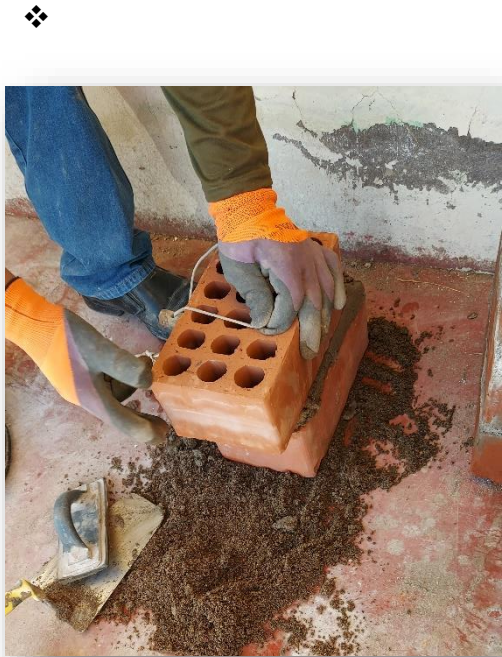
Figura 36.- elaboración de pilas para ensayo de cohesión
