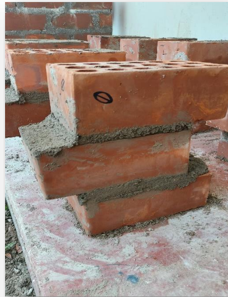
Figura 35.- pilas ya terminadas para el ensayo de cohesión de mortero con el ladrillo.
