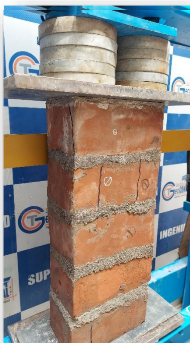
Figura 47.- falla de pila de albañilería por aplicación de cargas
