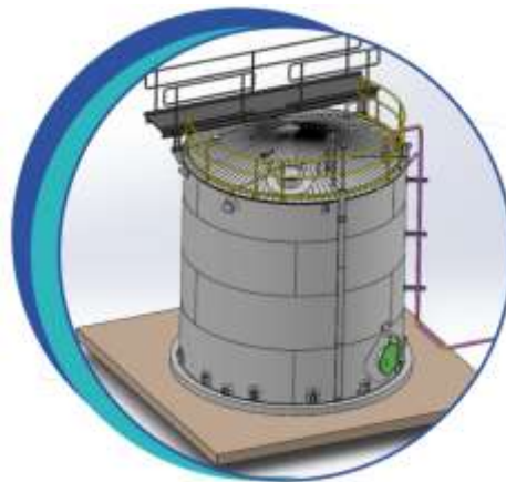
Figura 3. Tanque con techo auto - soportado
