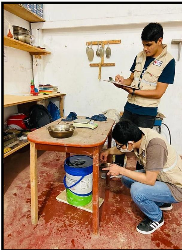
**Anexo 39:** Panel Fotográfico N° 10 – Prueba de humedad superficial del agregado fino.
