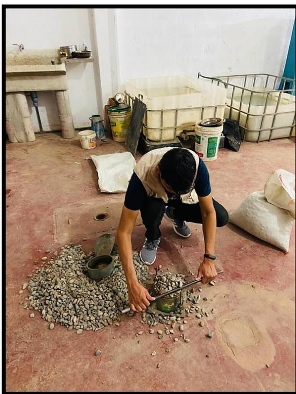
**Anexo 37:** Panel Fotográfico N° 08 – Proceso de llenado del agregado fino hasta la superficie del molde cilíndrico para el peso unitario compactado.
