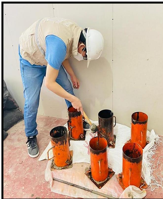
Anexo 47: Panel Fotográfico N° 18 - Rotura de probetas a compresión.
