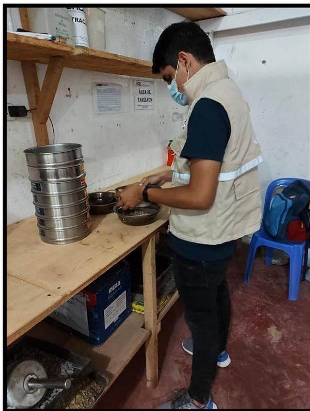
**Anexo 34:** Panel Fotográfico N° 05 – Proceso de lavado del agregado fino.
