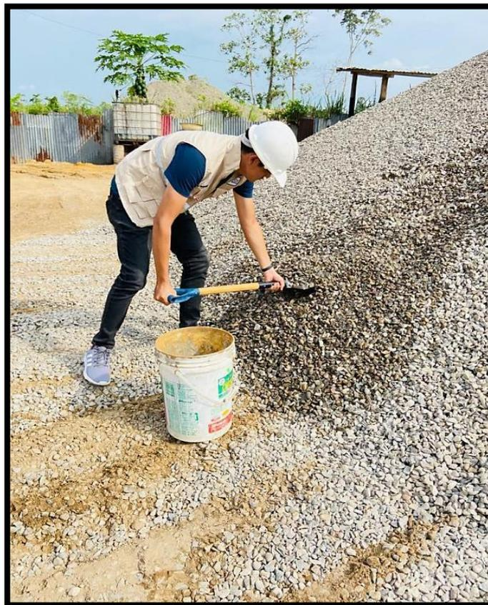
**Anexo 31:** Panel Fotográfico N° 02 - División del material mediante una cuarteada manual.
