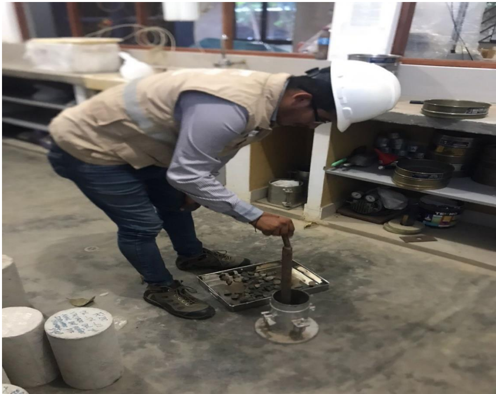
Foto N°06: Haciendo el ensayo peso unitario varillado del agregado Grueso.
