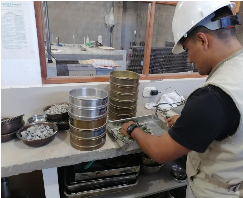
Foto N°10: Se verifica el vidrio molido para pasar por los tamices.
