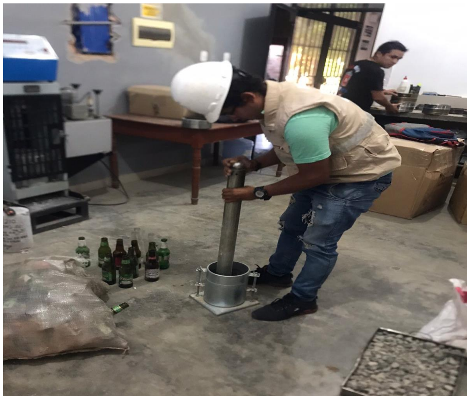
Foto N°08: Se precisa el proceso del vidrio molido manualmente con apoyo del martillo.
