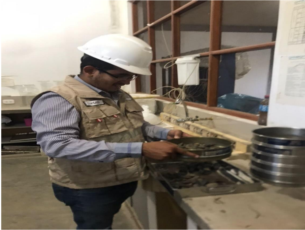
Foto N°05: Granulometría del agregado grueso.
