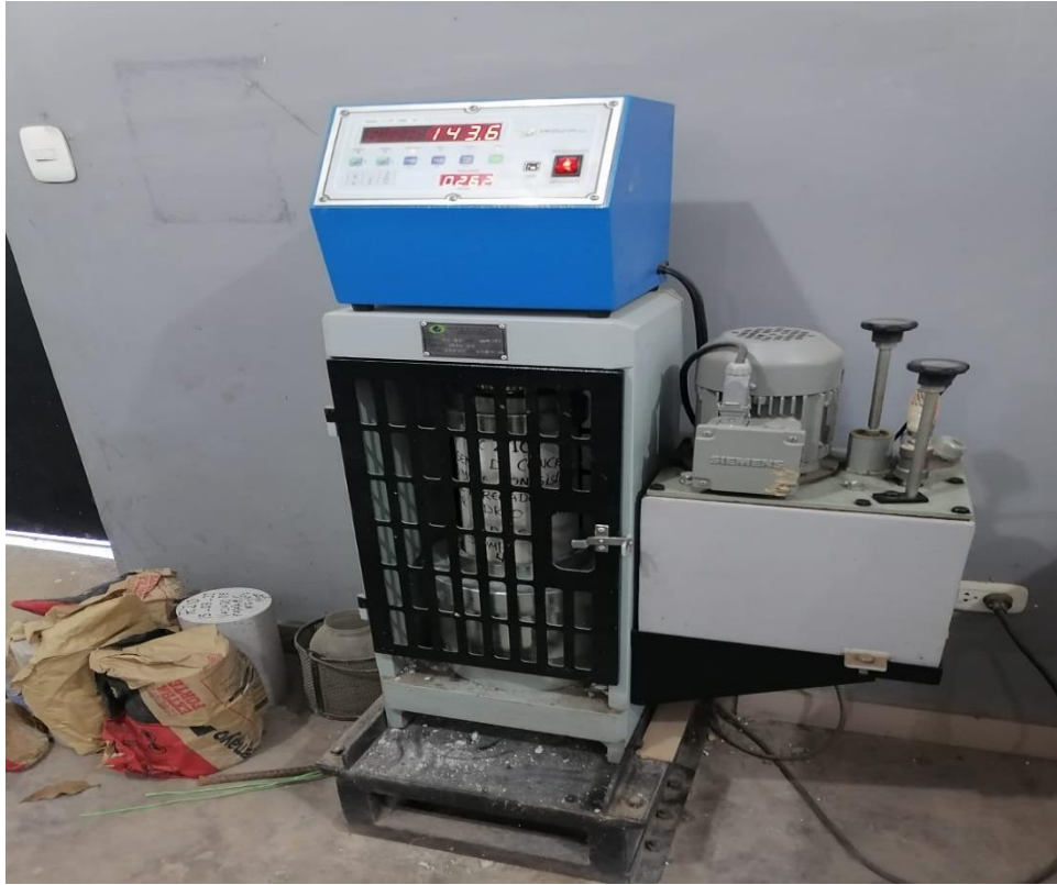
Foto N°12: Roturas de probetas a compresión.
