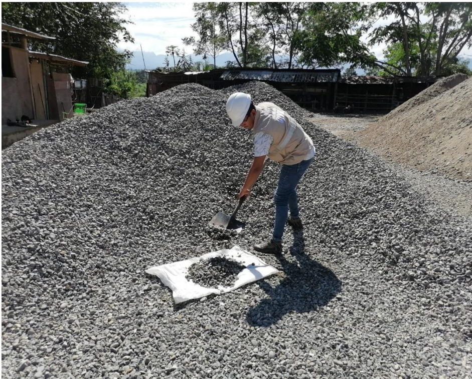
Foto N°02: Extracción de material grueso (piedra chancada).
