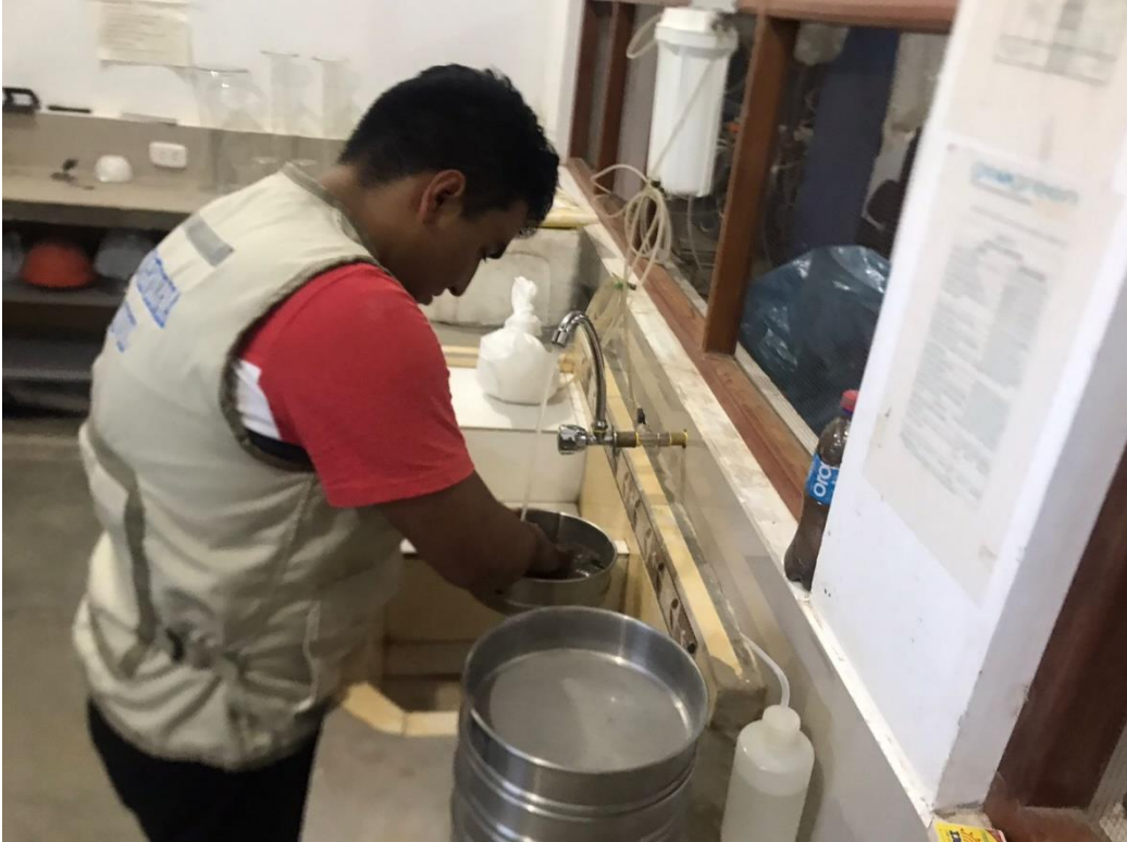
Foto N°03: Lavado del agregado fino pasando por el tamiz N°200 para eliminar los limos y arcillas.
