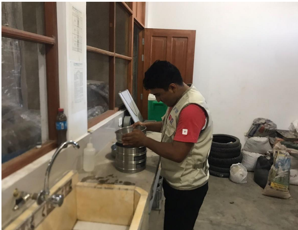
Foto N°04: Empezamos con la granulometría del agregado fino.
