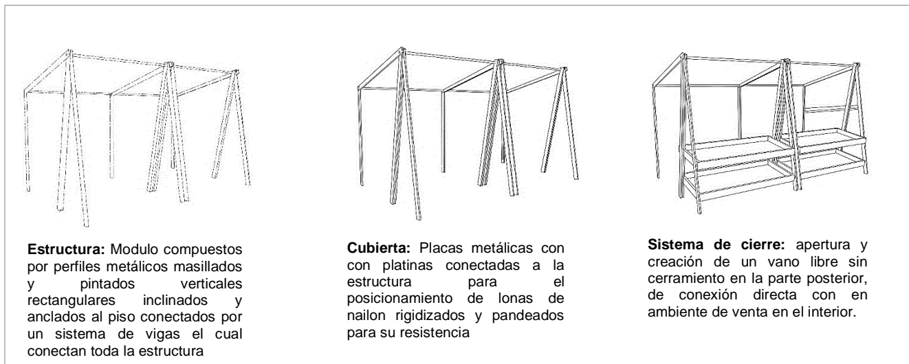
Figura 39. Estructura del módulo de venta itinerante
