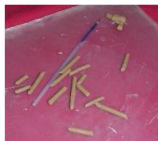
Rollitos de 3.2 mm de diámetro con grietas en su superficie.
