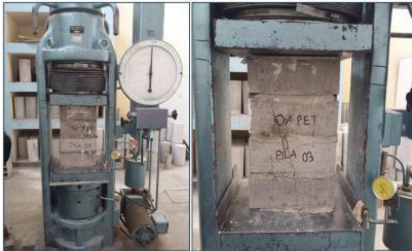
Ensayo de la compresión axial de pilas de ladrillo de concreto
