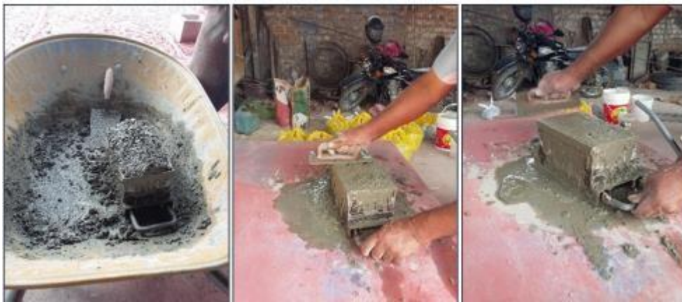
Fabricación de ladrillos con las mezclas de prueba
