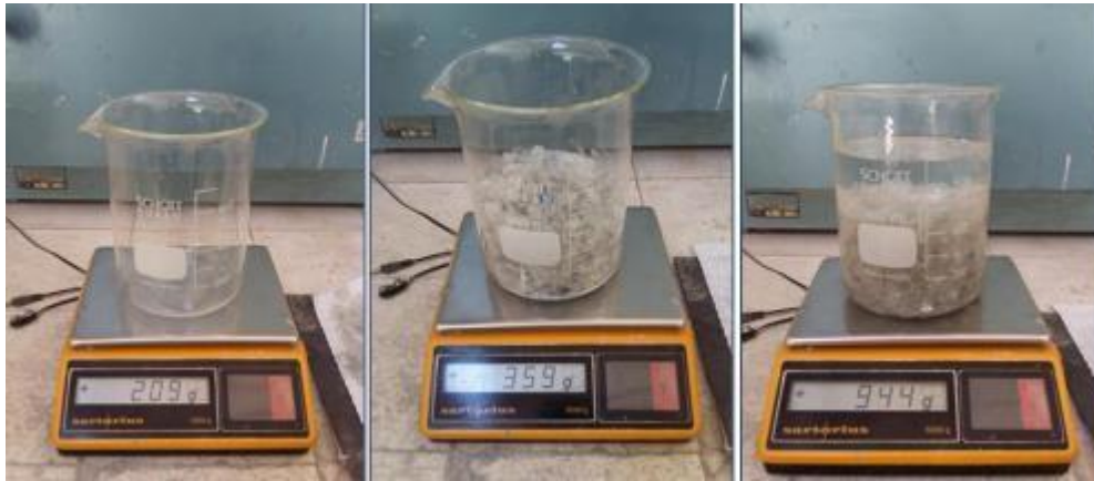
Recipiente vacío, con hojuelas de PET y con hojuelas de PET más agua
