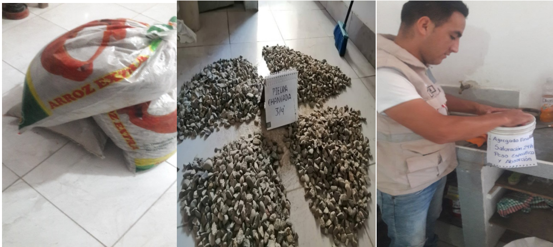
En la imagen se aprecia el proceso de clasificación y secado del agregado grueso y posteriormente la aplicación del ensayo de humedad natural.
