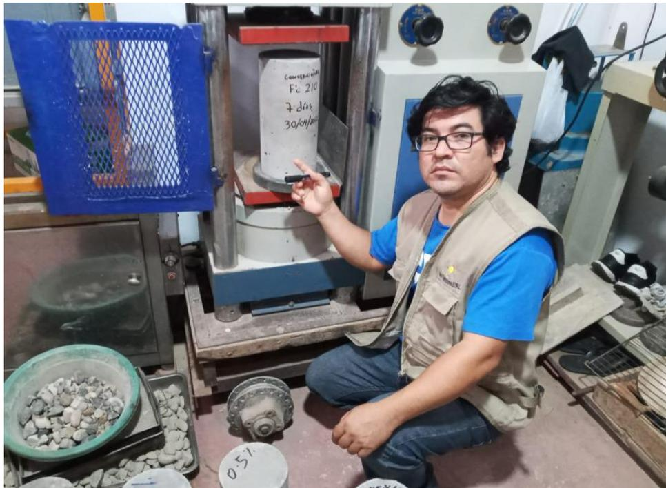
**IMAGEN Nº 04.** Ensayos de rotura de probetas
