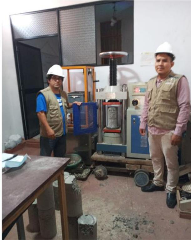
**IMAGEN Nº 03.** Prensa para la rotura de probetas
