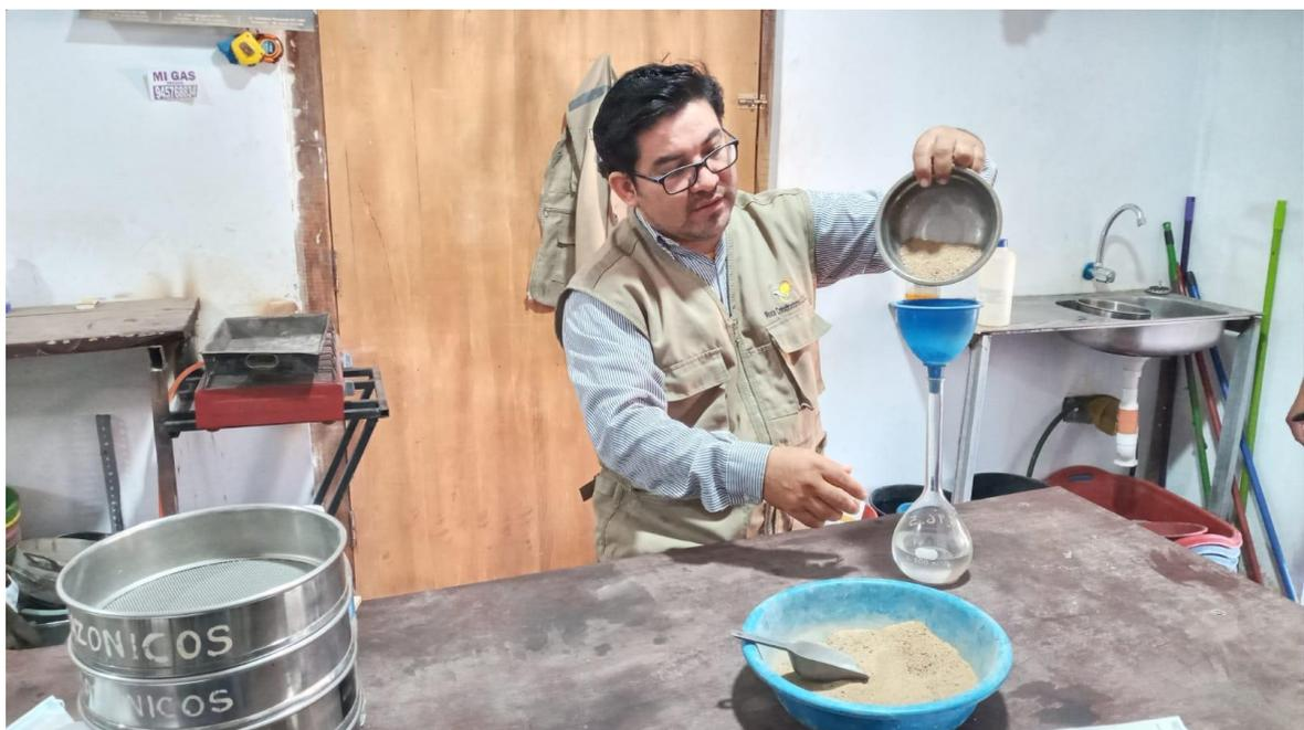
**IMAGEN Nº 08.** *Ensayo de humedad y peso específico*
