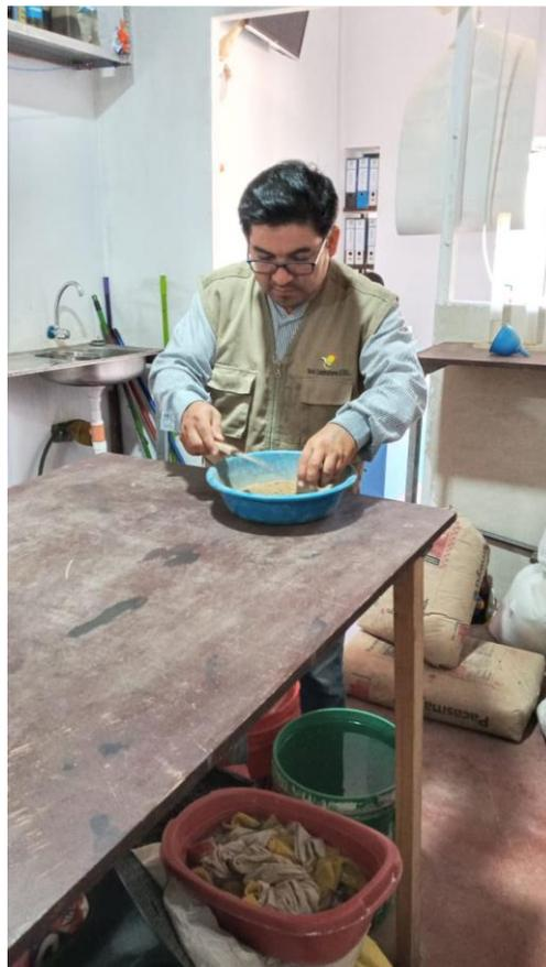
**IMAGEN N° 06.** Ensayo de equivalente de arena
