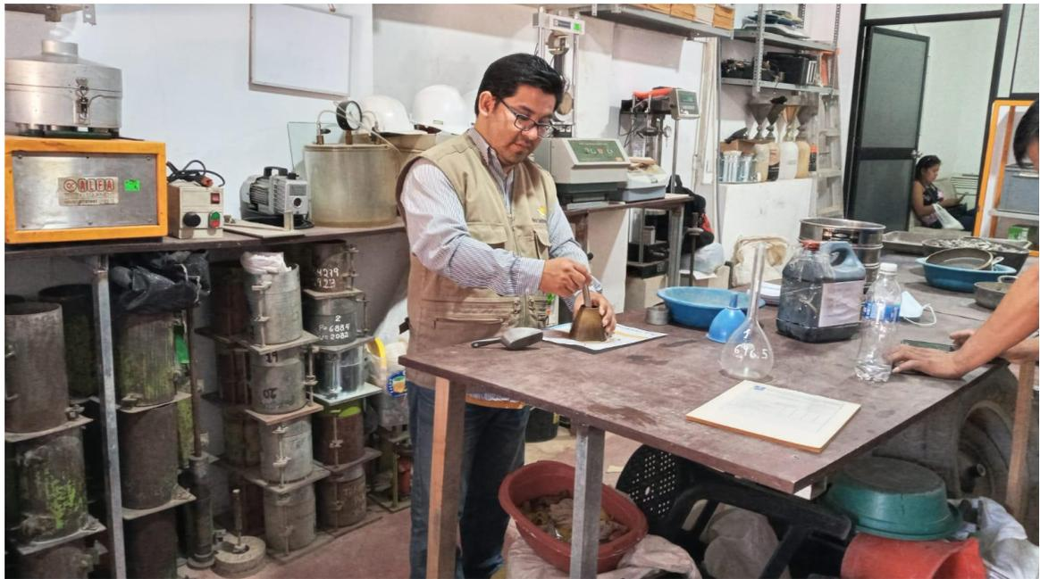
**IMAGEN Nº 07.** *Ensayo de humedad y peso específico*
