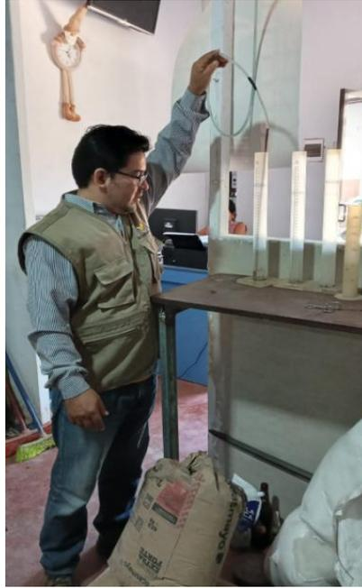
**IMAGEN N° 05.** Ensayo de equivalente de arena
