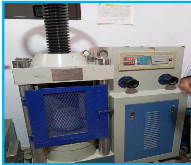
REALIZANDO LA ROTURA DEL DISEÑO
