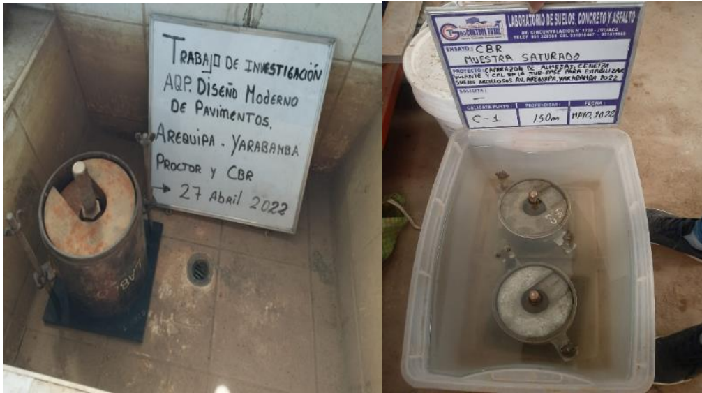
Figura 24: Briqueta del ensayo CBR.
