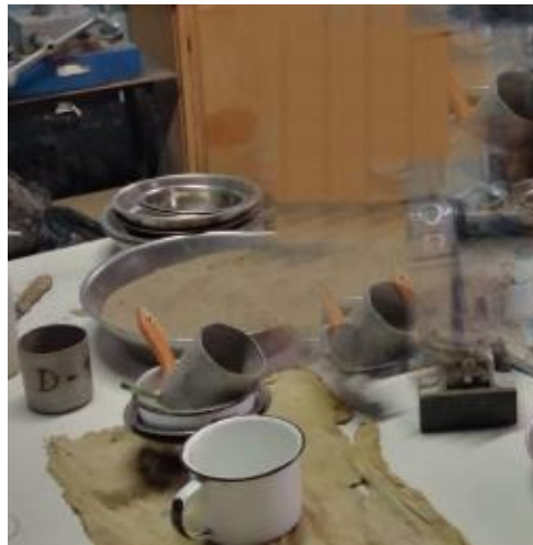
Figura 19. Colocado de la muestra a la cuchara de Casagrande.
