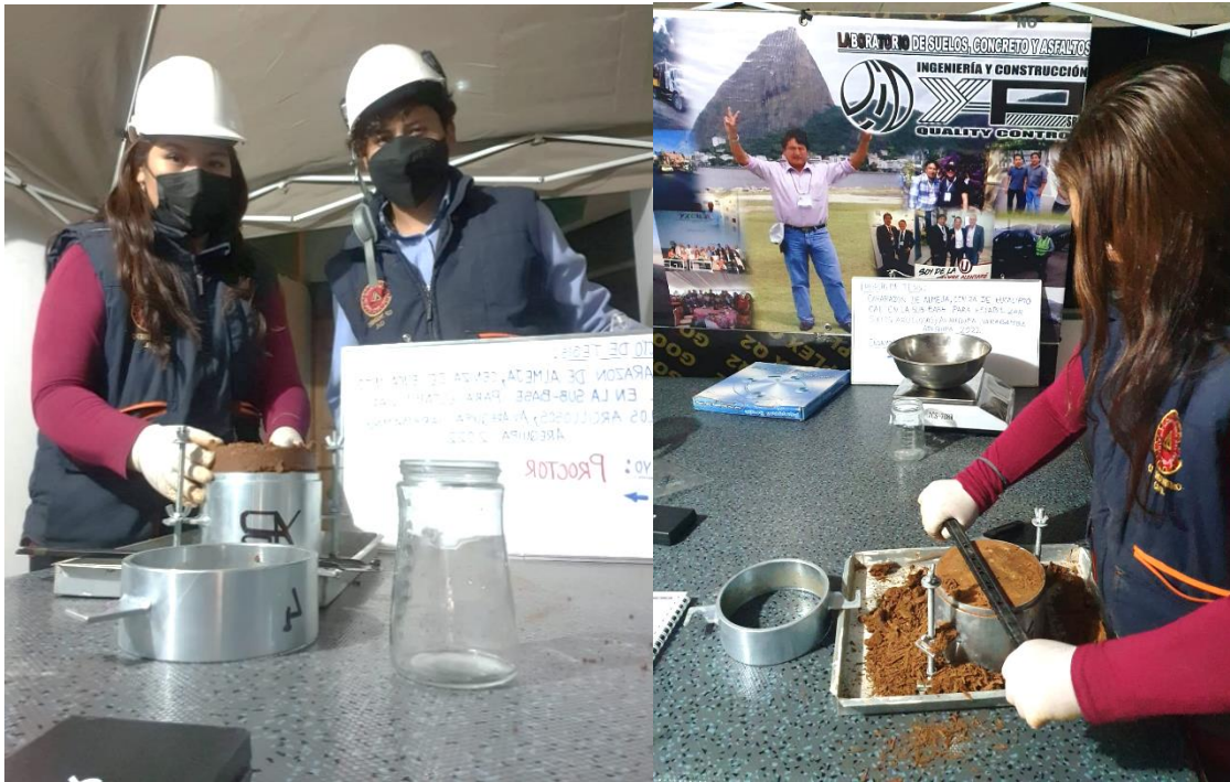
Figura 23: Enrasado del molde
