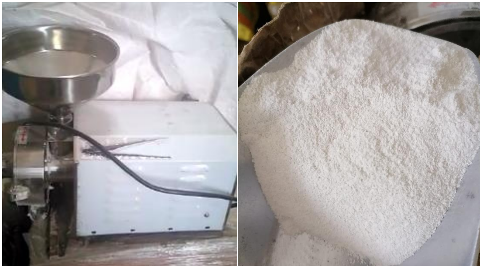
Figura 13: Proceso de trituración del Caparazón de Almejas.
