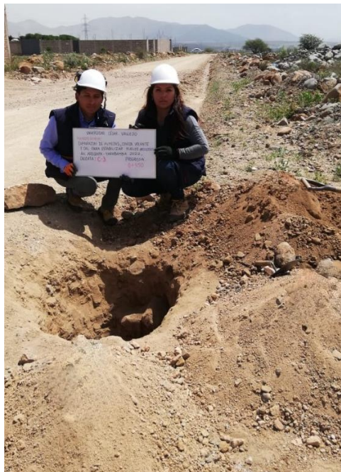
Figura 7: Extracción de material - Calicata N°3
