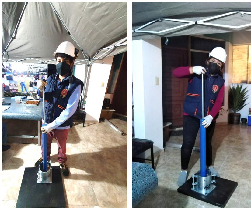
Figura 22: Compactado con pisón 56 golpes.
