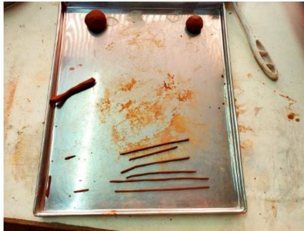
Figura 20. Muestra del Límite Plástico.
