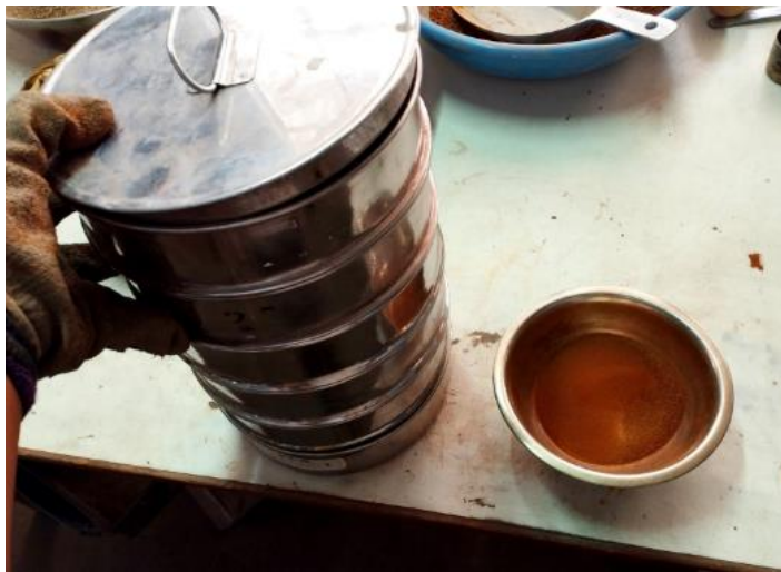
Figura 18: Tamizado del suelo
