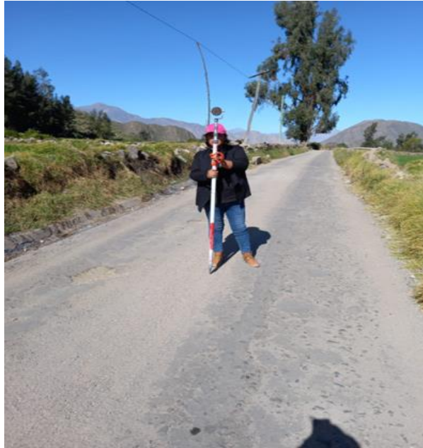
Figura 16. Levantamiento con Estación Total a nivel de eje de vía
