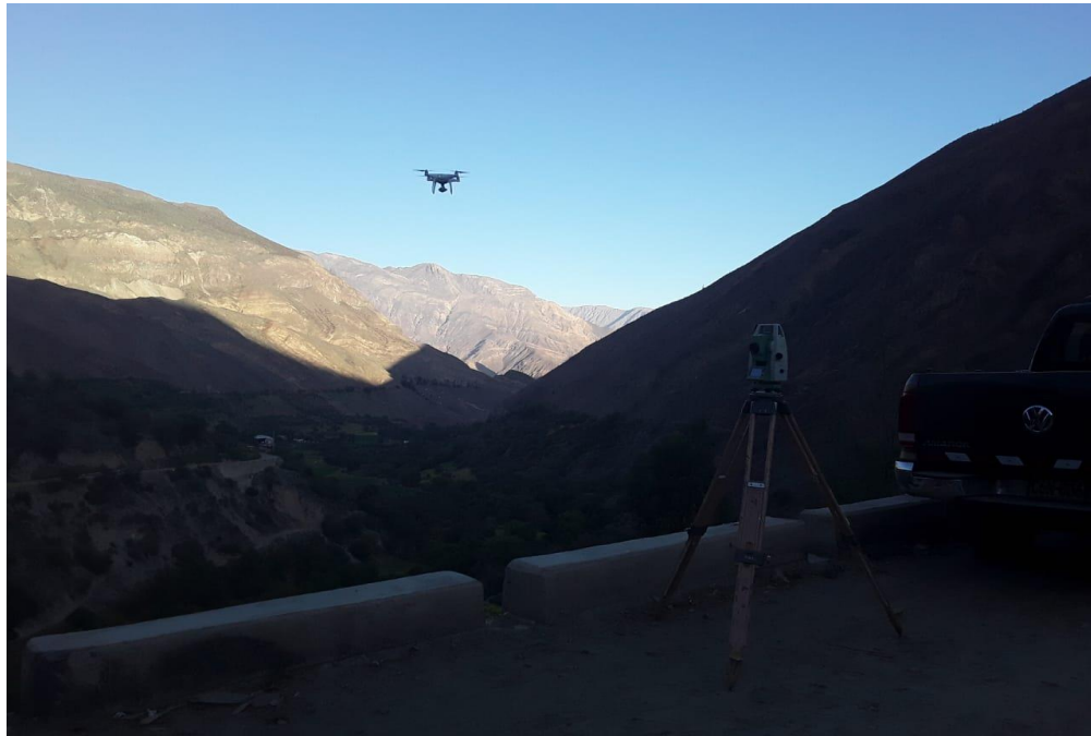
Figura 18. Levantamiento con Dron y Estación Total
