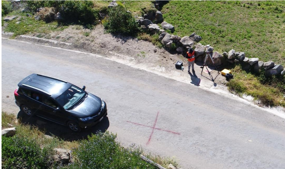
Figura 12. Punto base en BM de control
