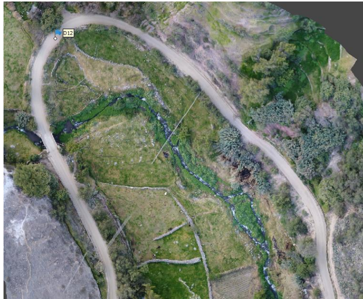
Figura 30. Orto foto ya georreferenciada al sistema WGS 84
