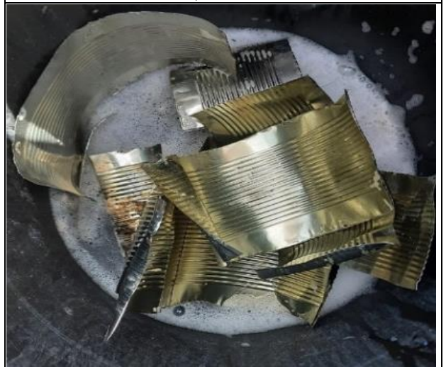
Fotografía N°4: Una vez realizado el corte, se procede a ser lavado con detergente para eliminar los restos que contiene
