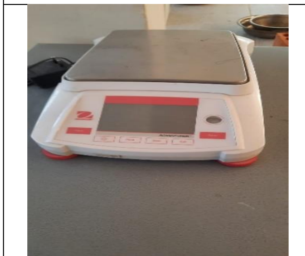
Fotografía N°23: balanza para realizar los pesos de los materiales que serán utilizados en este proyecto.
