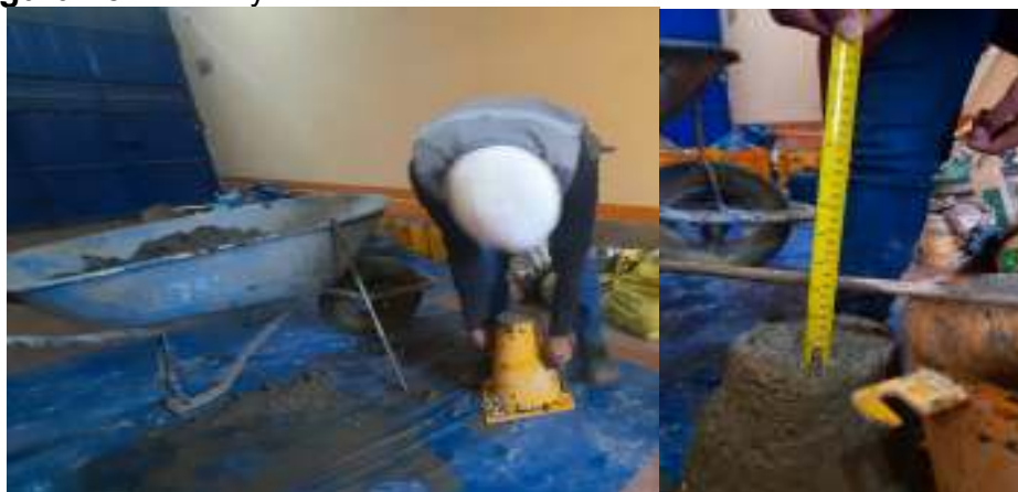
Figura 29. Ensayo de asentamiento del concreto con el cono de abrams
