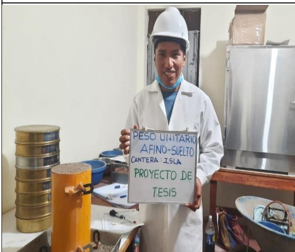
Fotografía N°9: Medición Peso unitario del agregado fino suelto
