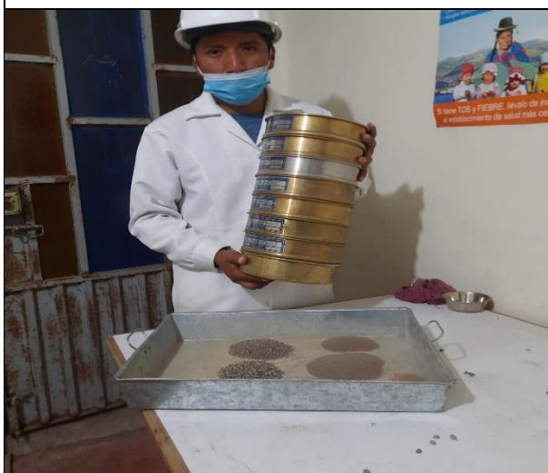
Fotografía N°15: Tamizado del agregado fino
