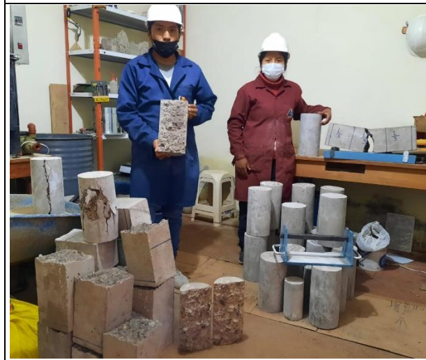
Fotografía N°40: Rotura de resistencia a compresión
