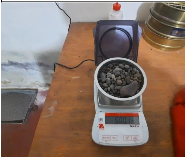
Fotografía N°17: Peso del agregado grueso.
