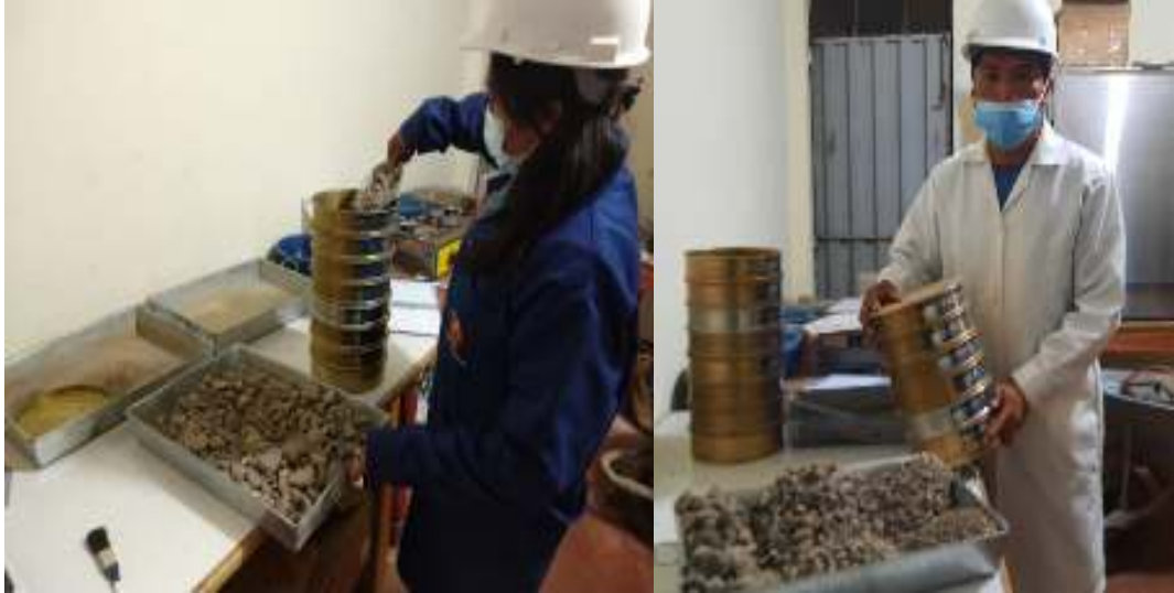
Figura 22. Tamices para realizar el ensayo de análisis granulométrico:
