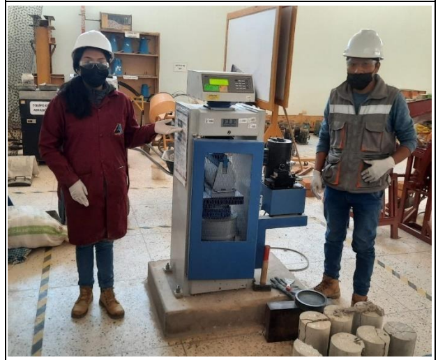
Fotografía N°34: Rotura de Resistencia a tracción
