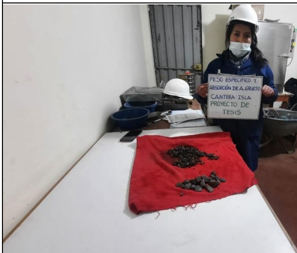
Fotografía N°19: Peso específico y absorción del agregado grueso.
