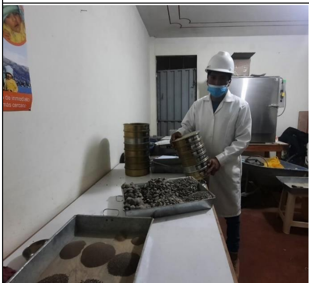
Fotografía N°13: Tamizado del agregado grueso
