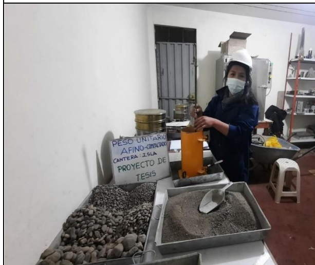
Fotografía N°10: Medición peso unitario agregado fino
