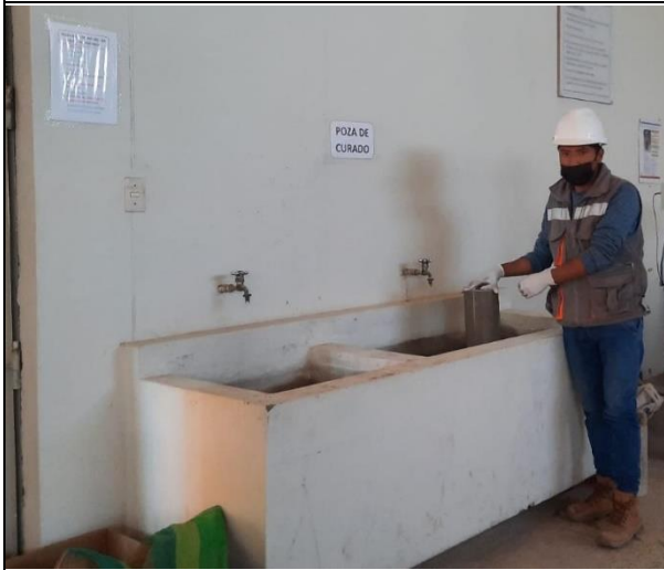
Fotografía N°33: Curado de las probetas
