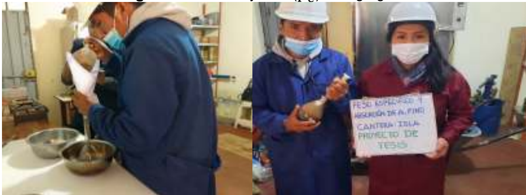
Figura 27. ensayo del ( p_e ) del agregado fino
