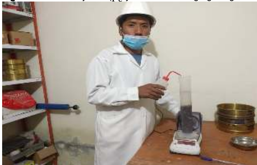
Figura 28. Ensayo del ( p_e y absorción del agregado grueso
