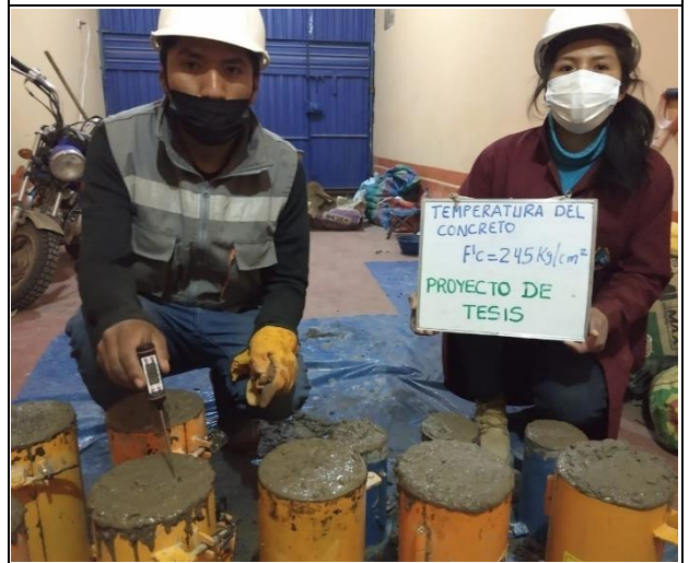
Fotografía N°28: Medición de la temperatura al concreto
