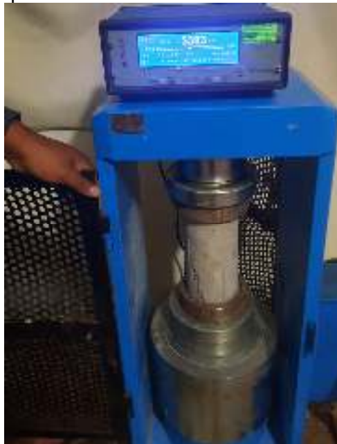
Figura 42. probetas sometidas a resistencia a la compresión
