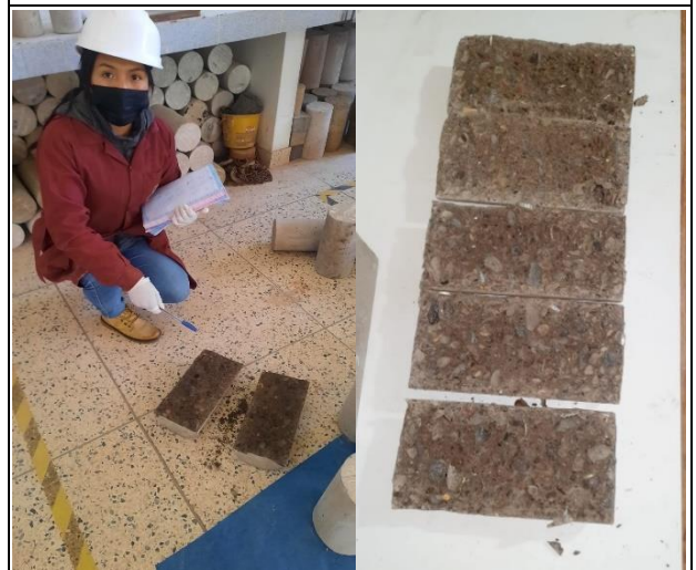
Fotografía N°36: Verificación de la rotura en tracción
