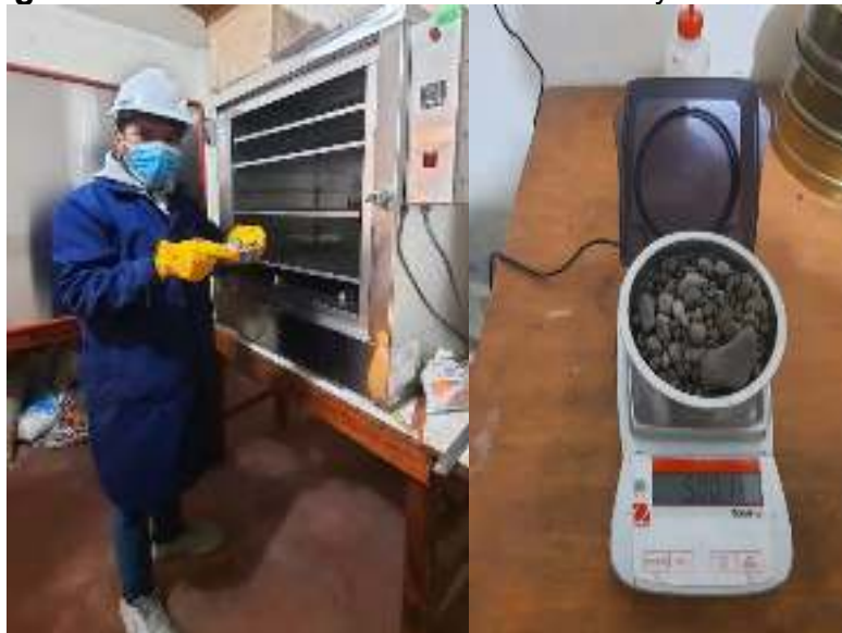
Figura 25. Contenido de humedad del A.G. y A.F.
