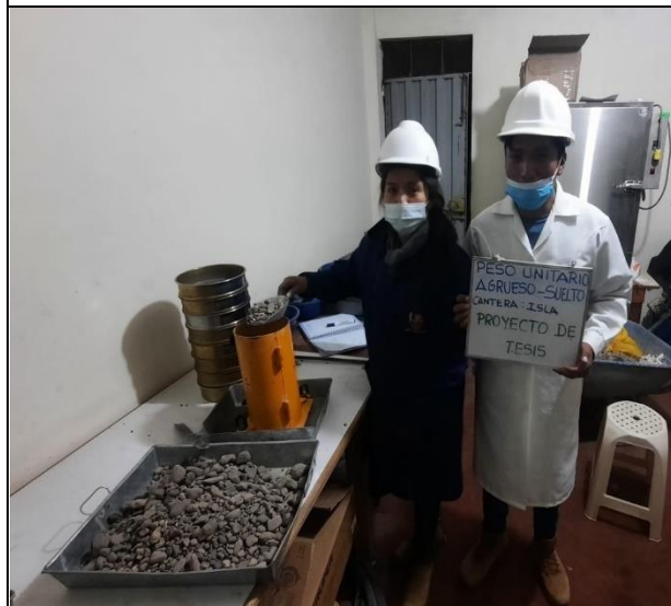
Fotografía N°14: Medición Peso unitario del agregado grueso suelto
