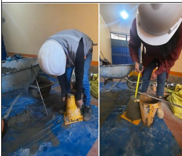
Fotografía N°29 Asentamiento del concreto
