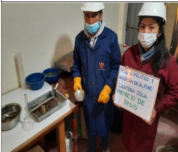
Fotografía N°21: Peso específico y absorción del agregado fino
