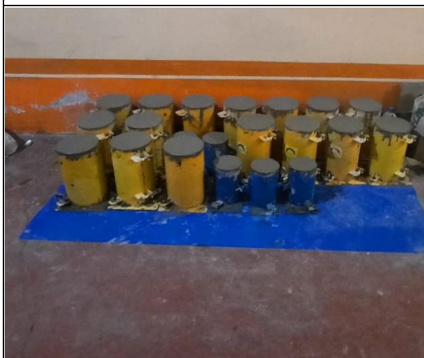
Fotografía N°30: Elaboración de las probetas y vigas de concreto.
