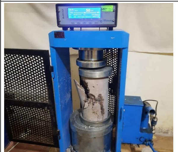
Fotografía N°37: Rotura de resistencia a compresión
