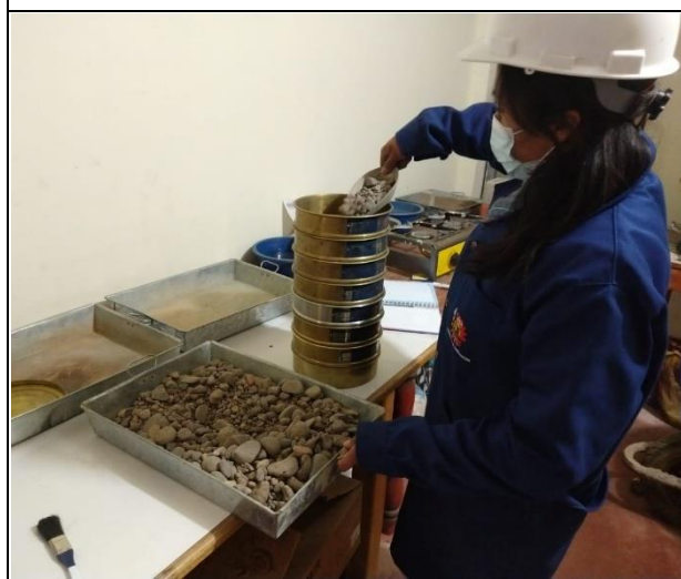
Fotografía N°16: Tamizado del agregado grueso
