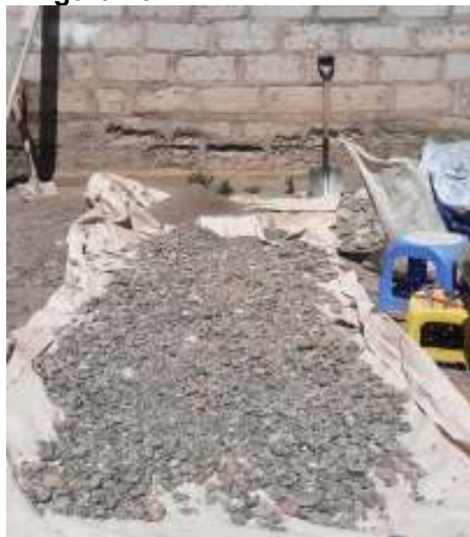
Figura 13. Secado del material
