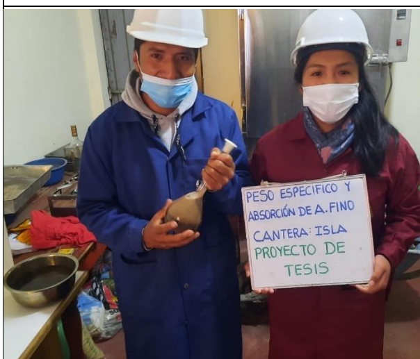
Fotografía N°23: Peso específico y absorción del agregado fino
