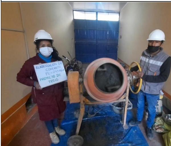
Fotografía N°27: Elaboración del concreto.
