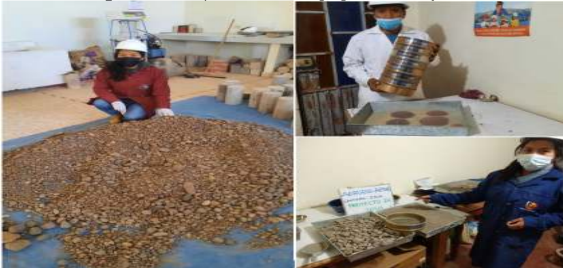
Figura 14. Separación de los agregados en AG y AF
