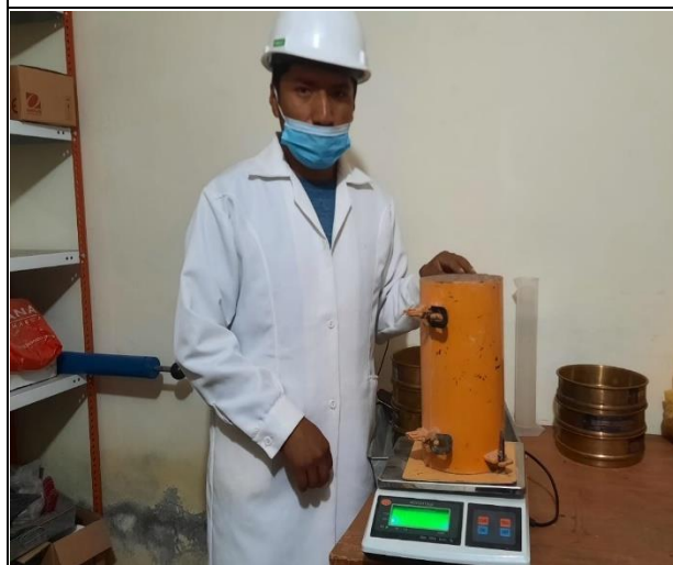
Fotografía N°12: Peso del agregado fino en probetas.
