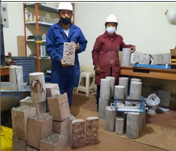
Fotografía N°39: Rotura de resistencia a compresión
