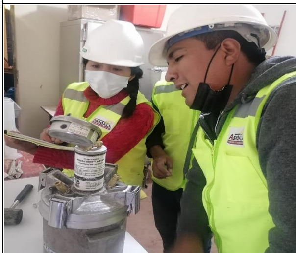
Fotografía N°31: Toma de datos ensayo de contenido de aire
