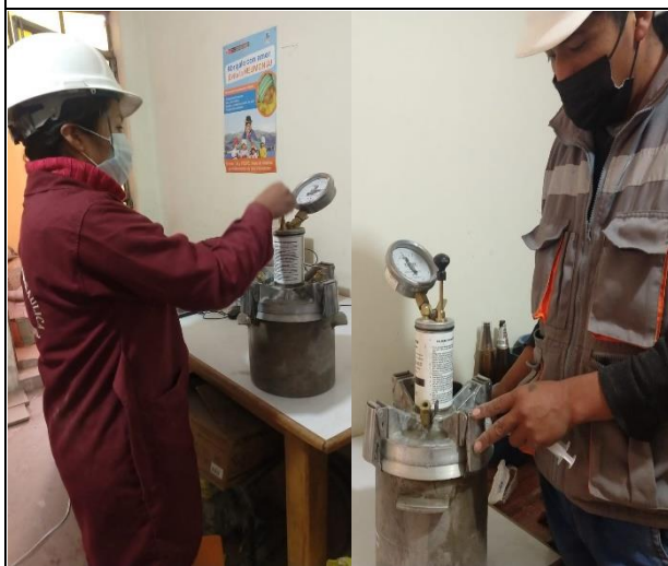
Fotografía N°32: Ensayo con la Olla de Washington
