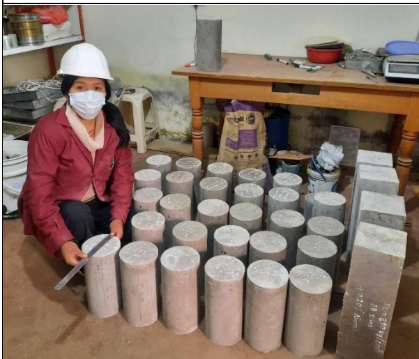
Fotografía N°35: Medición de las probetas y vigas
