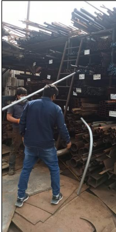
Figura N° 12: Trabajadores sin sus Equipos de Protección Personal descargando material del área de producción
