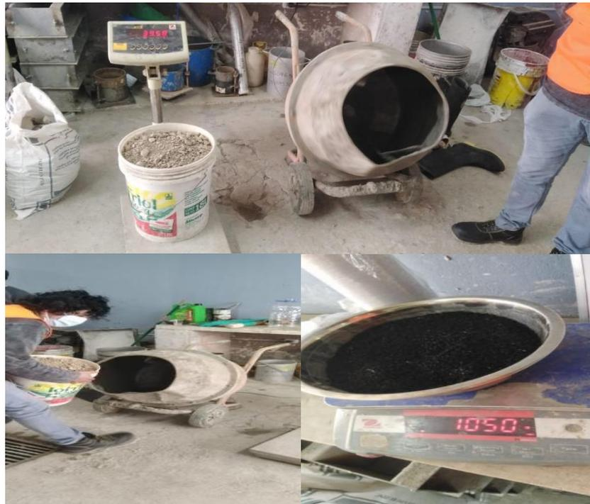
Figura N° 13. Mezcla de Concreto 3%, 7% y 10% de caucho
