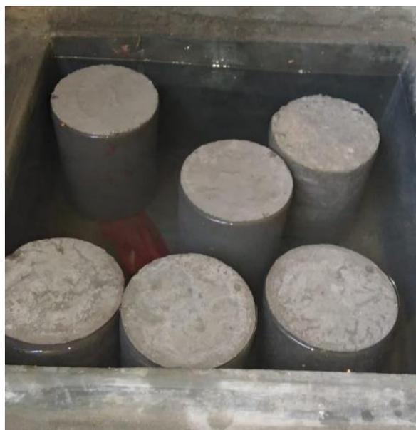
*Figura N° 16. Curado del concreto patrón*
