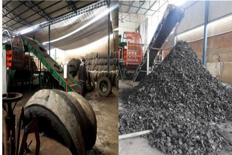
*Figura N° 6.* Almacenamiento y triturado de caucho reciclado
