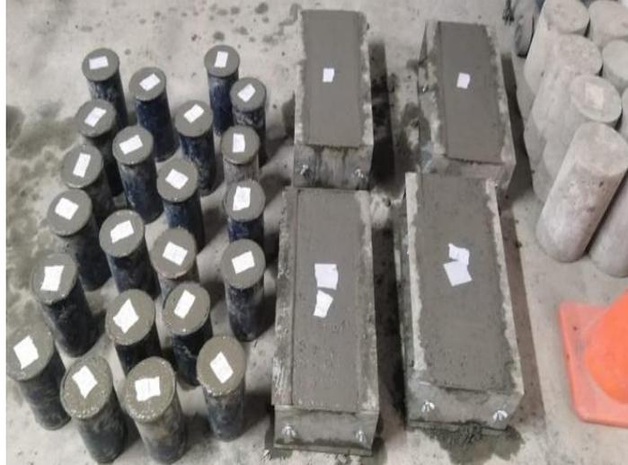
*Figura N° 15. Vaciado de concreto con 3%, 7% y 10 % de caucho*
