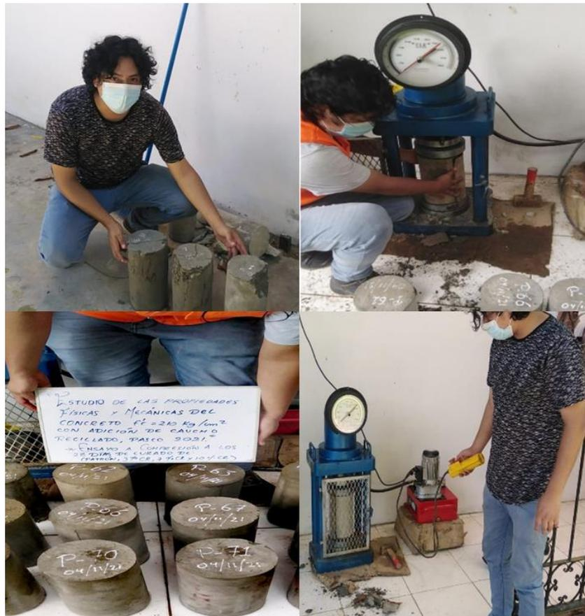
*Figura N°17.* Ensayo a compresión de probetas cilíndricas
