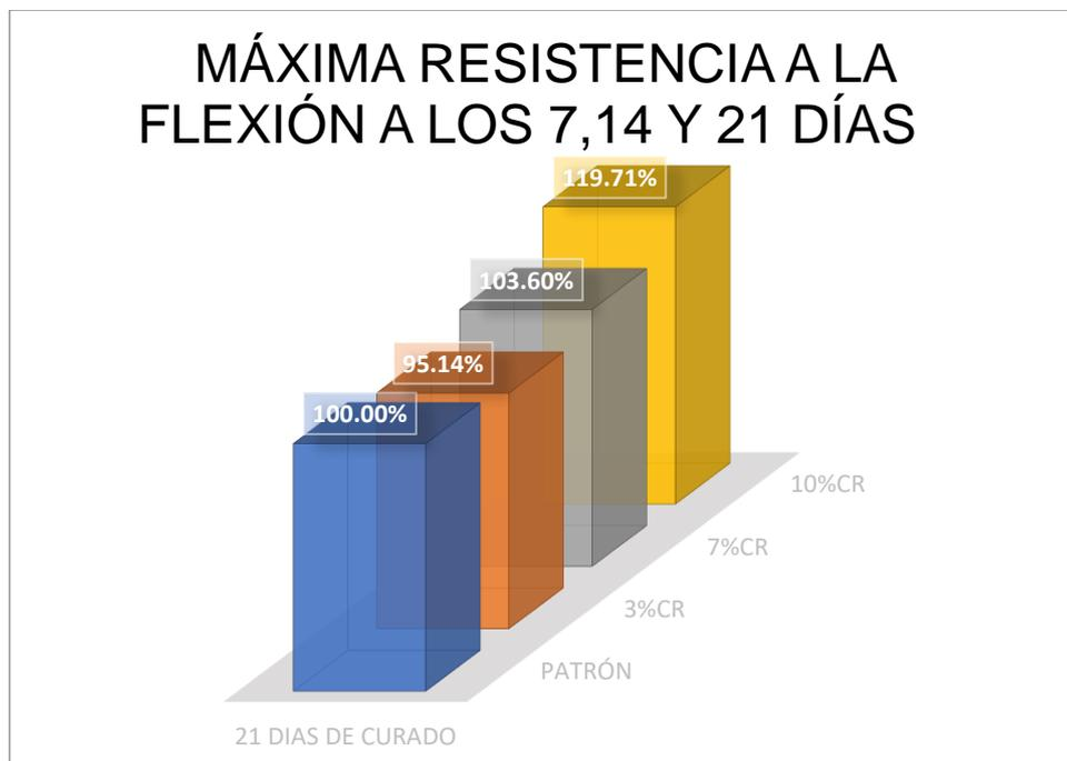
Gráfico N°15: Máxima resistencia a flexión a los 7, 14 y 21 días de curado de las mezclas patrón, 3%CR, 7%CR y 10%CR
