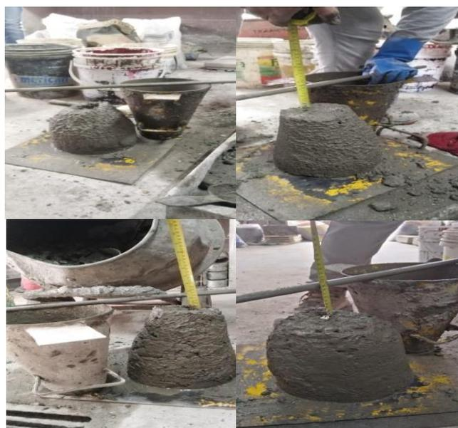
Figura N° 14. Ensayo de Slump de 3%, 7% y 10 % de caucho
