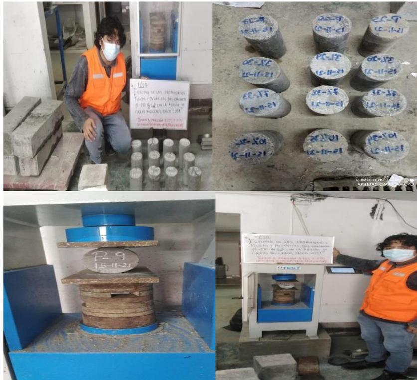
Figura N° 18. Ensayo a tracción diametral de probetas cilíndricas de concreto patrón, 3%, 7% y 10% de caucho
