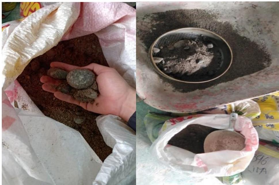
*Figura N° 9. Tamizaje manual del hormigón*
