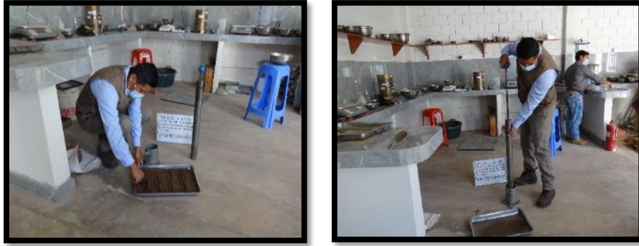
Figura 64. Ensayo de Proctor modificado
