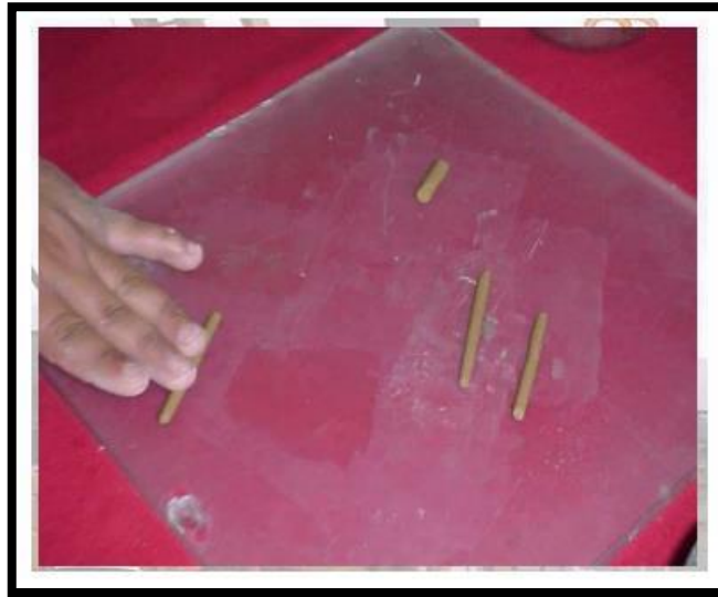
Figura 15. Determinación de límite plástico. Fuente propia
