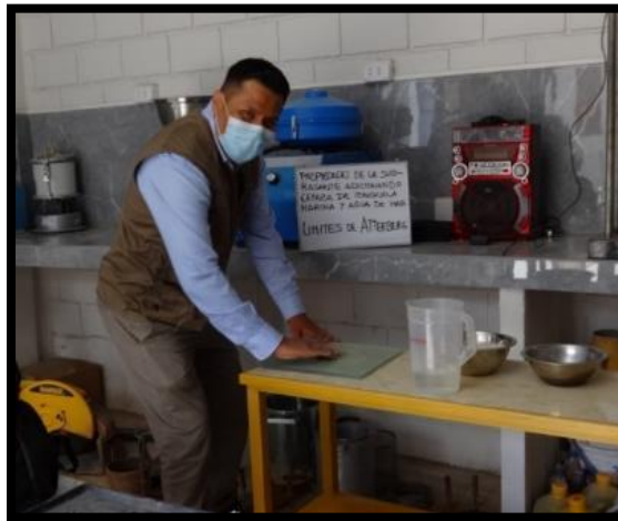
Figura 47. Determinación del límite plástico. Elaboración propia.
