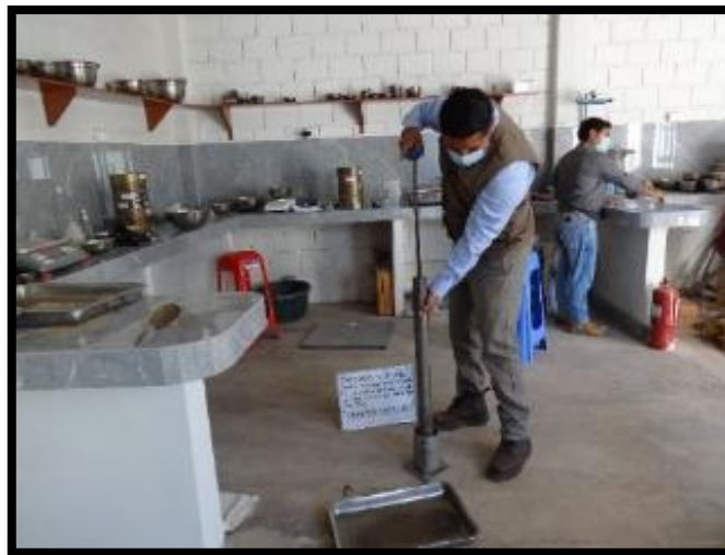
Figura 52. Apsonado por capas. Elaboración propia.
