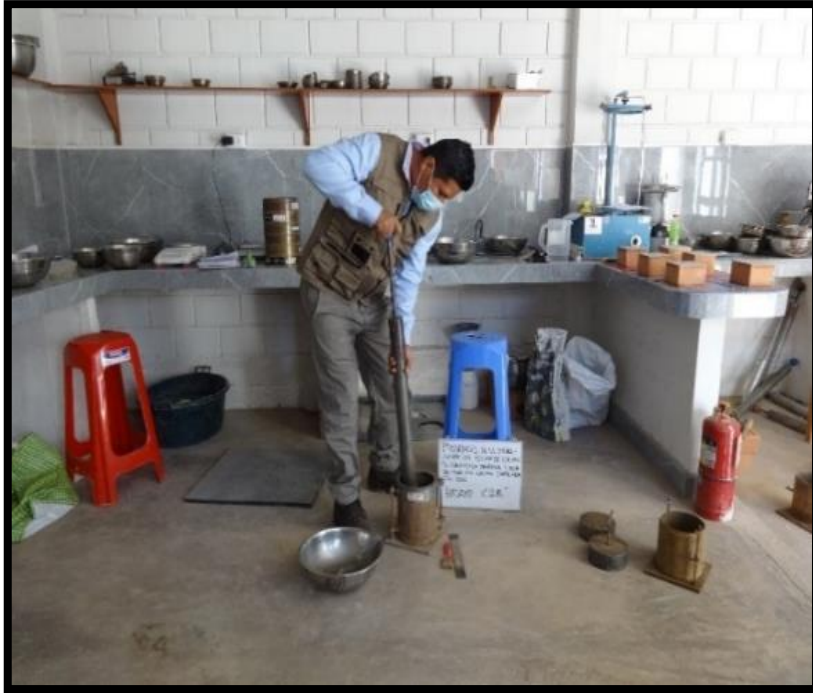
Figura 57. Realizando golpes de compactación. Elaboración propia.
