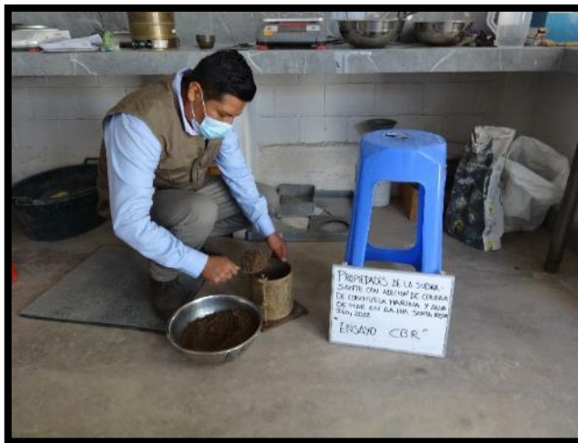
Figura 56. Conformando las capas. Elaboración propia.
