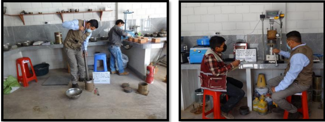
Figura 69. Ensayo de capacidad portante (CBR). Elaboracion propia.
