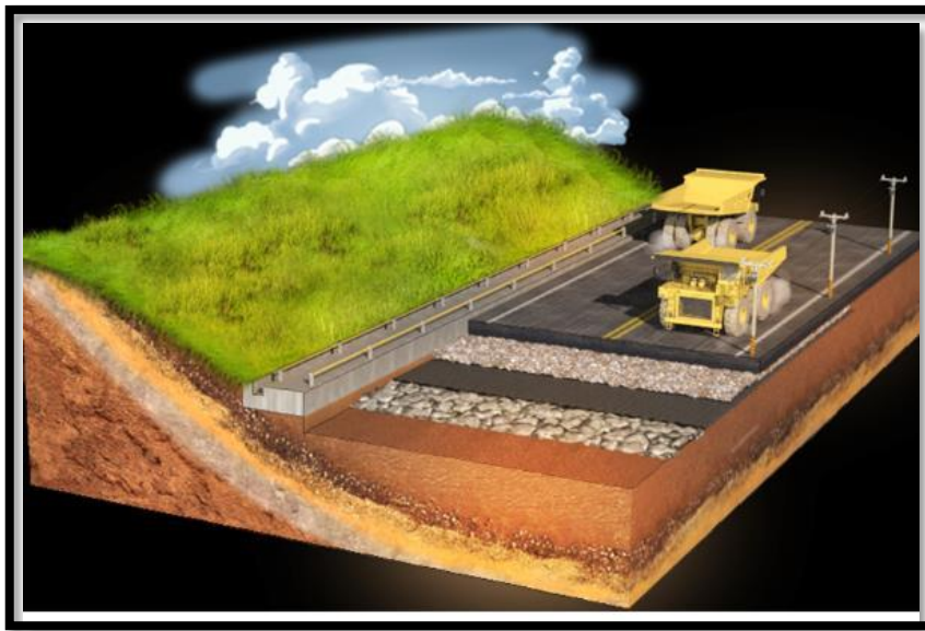
Figura 11. Mejoramiento de subrasante. Fuente propia
