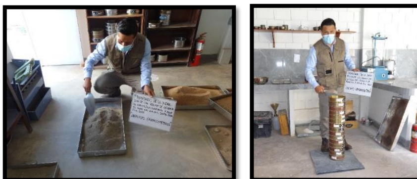
Figura 74. Ensayo de granulometría adicionando (CCM) y (AM). Elaboracion propia.
