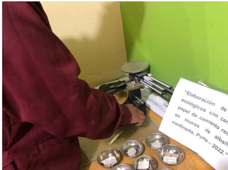
Figura 21. Vista de elaboración límite líquido de la muestra de arcilla.
