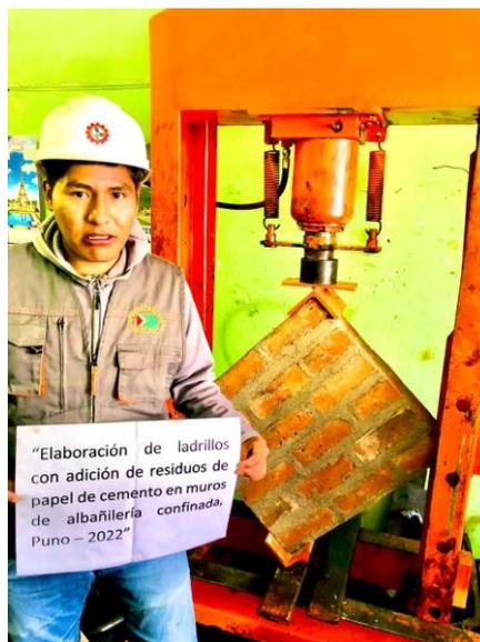
Figura 35. Vista de elaboración de ensayo a compresión axial en muretes.
