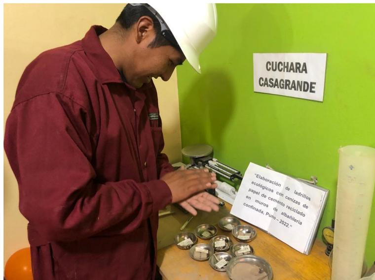
Figura 22. Vista de elaboración de límite plástico de la muestra de arcilla.
