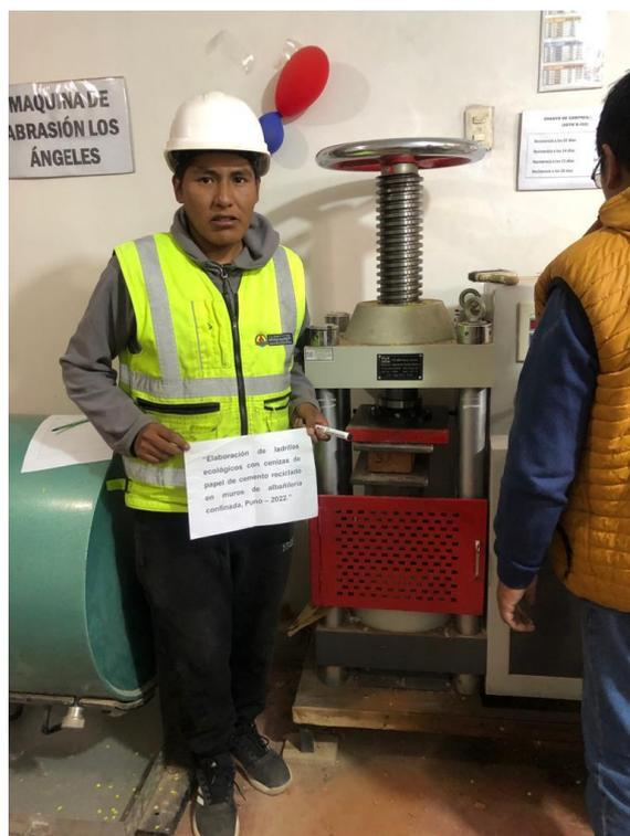
Figura 31. Ensayo de compresión en las unidades de ladrillo.
