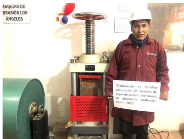
Figura 33. Vista de elaboración de ensayo a compresión axial en pilas.
