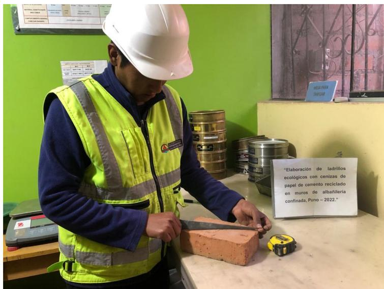
Figura 25. Elaboración de ensayo de alabeo en unidades de ladrillo.
