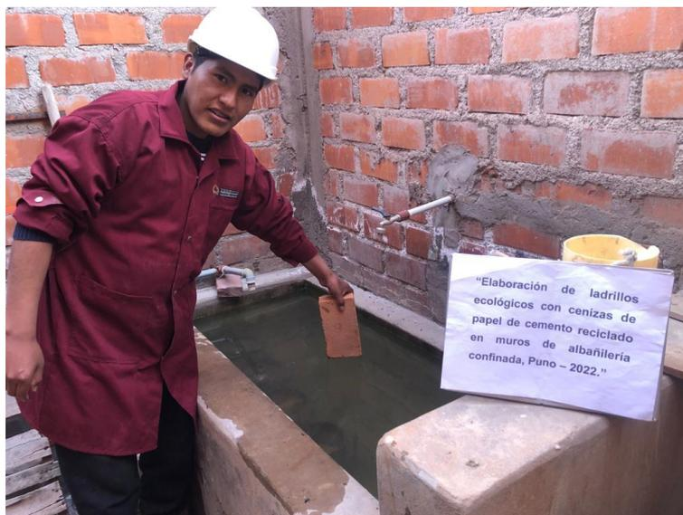
Figura 29. Elaboración de ensayo de absorción de agua en las unidades de ladrillo.
