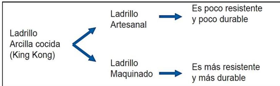
Figura 5. Diagrama de tipos de ladrillos.
