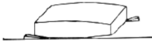
Figura 16: Alabeo por convexidad de una superficie
