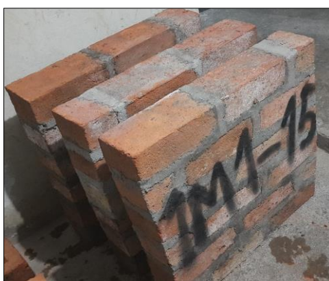
Figura 33: Muestras del ensayo de compresión diagonal de muretes V'm
