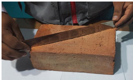
Figura 26: Ensayo de alabeo
