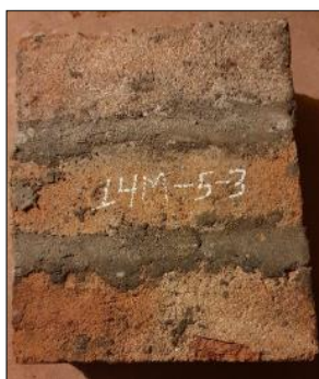
Figura 31: Muestra para el ensayo de compresion de pilas F'm
