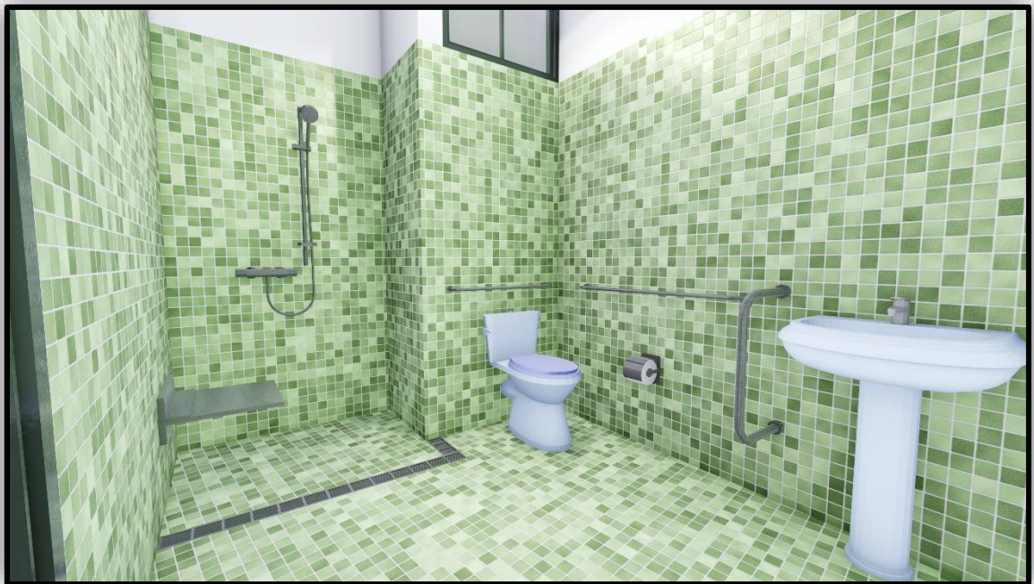
Vista 08: vista de los servicios higienicos, se observa la ducha acondicionada para el adulto mayor dependiente (superficie plana sin obstaculos).
