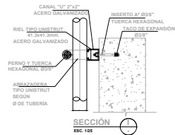
SOPORTE PARA TUBERÍA VERTICAL DESAGUE Y VENTILACIÓN
