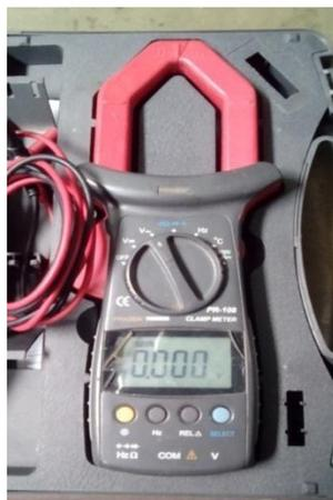
Figura N° 2.3 Se muestra la pinza amperimétrica usada para medir la corriente en cada circuito instalado.
