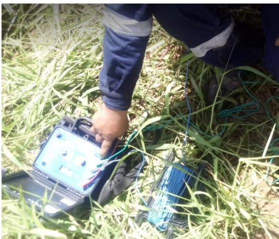
Figura 14: Resistividad con 2 metros de distancias entre electrodos.
