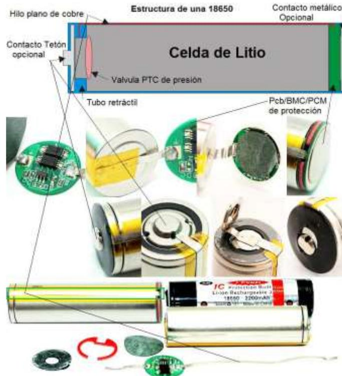
Figura 1. Estructura de la batería 18650
