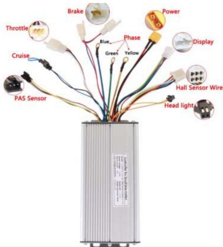
Figura 7. Controlador eléctrico para bicicleta eléctrica.
