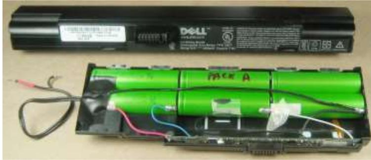
Figura 2. Celdas 18650 de batería de laptop
