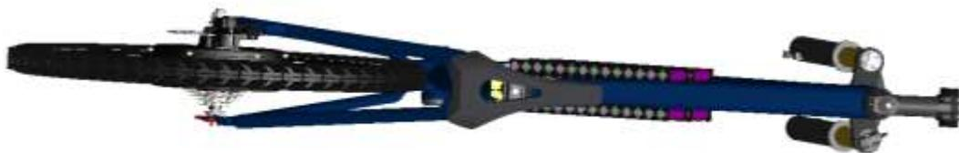
Figura 73. Vista superior bicicleta eléctrica y nuevo banco de baterías 48V 20Ah (14S 8P)
