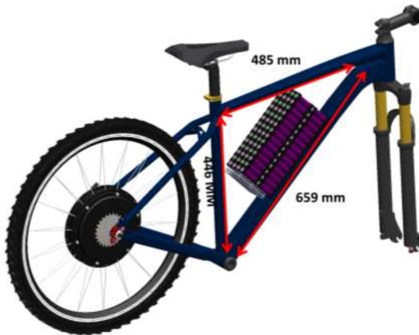
Figura 72. Bicicleta eléctrica y nuevo banco de baterías 48V 20Ah (14S 8P)
