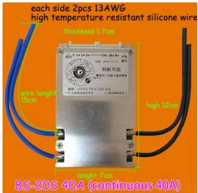
Figura 45. BMS de 8 a 20 series y hasta 40 amperios
