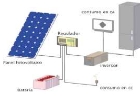
Figura 1: Esquema de conexión general de un sistema fotovoltaico autónomo
