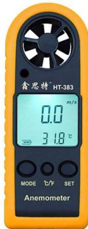
**Figura 7.** *Equipo para la medición de la velocidad y dirección del viento*
