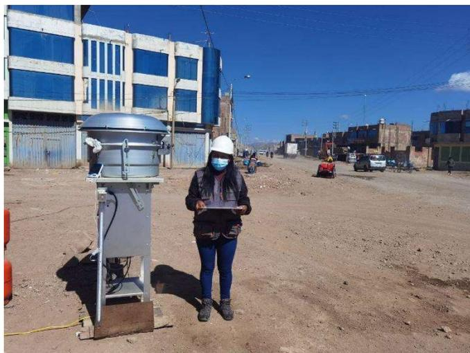
**Figura 3.** *Instalación del equipo Hi-Vol*
