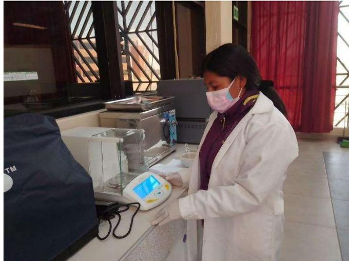
**Figura 6.** *Pesaje final del filtro para determinar la concentración de  $PM_{10}$*
