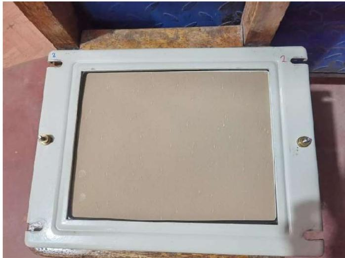
**Figura 5.** *Obtención del filtro del equipo Hi-Vol posterior al monitoreo de  $PM_{10}$*
