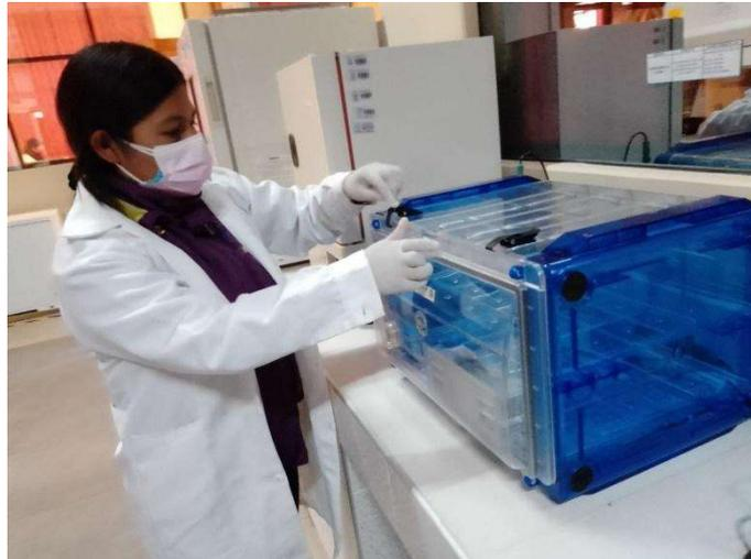
**Figura 2.** *Deseccación del filtro para su utilización en el equipo Hi-Vol*
