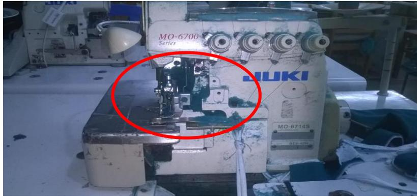
*Figura 34. Maquina remalladora en mal estado*
