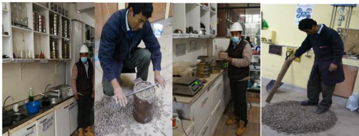
Figura 9: Procedimientos de ensayo de análisis granulométrico.
