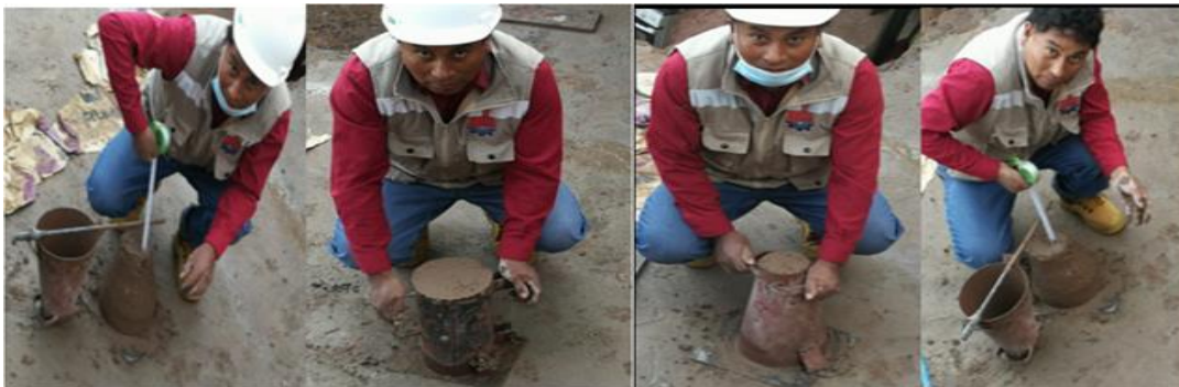
Figura 16: Elaboración de briquetas y asentamiento del concreto.
