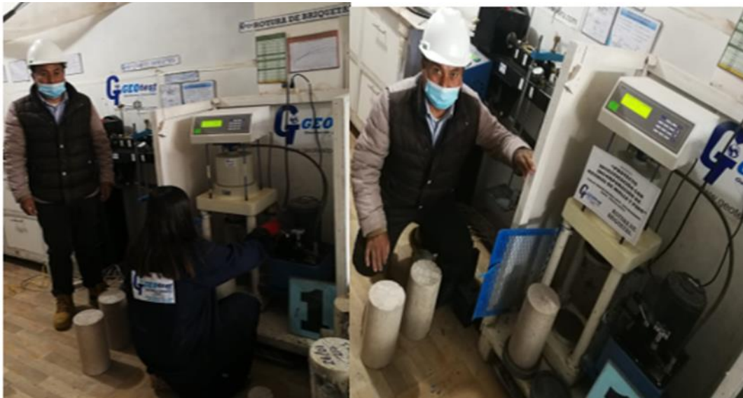
Figura 23: Imagen fotográfica de rotura de briquetas a 7 días de moldeado.
