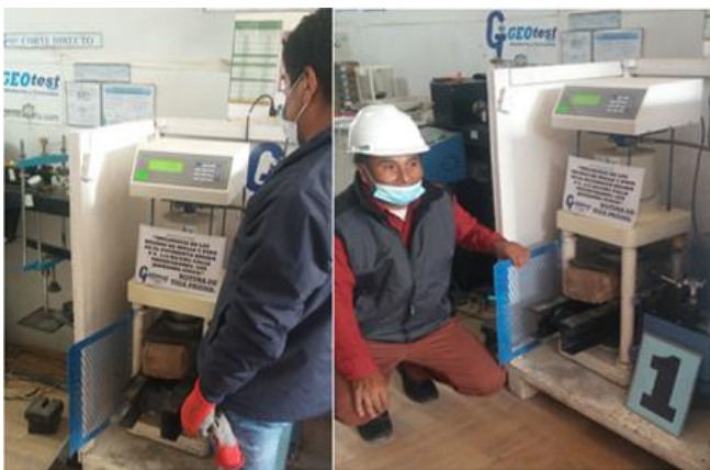
Figura 35: Imagen de resistencia a flexion de vigas prisma de concreto.
