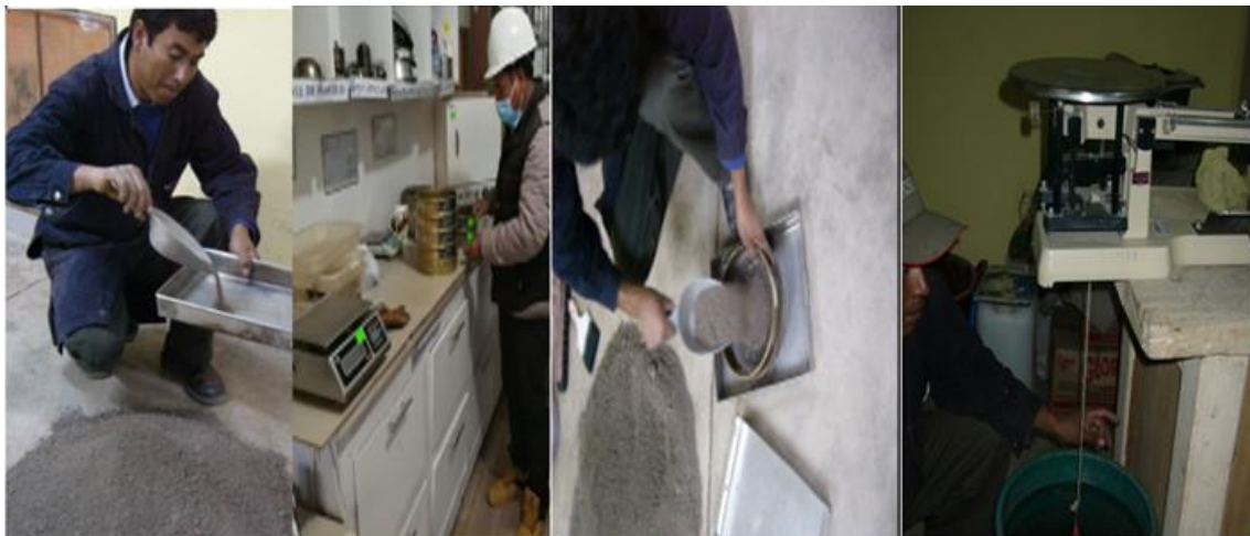
Figura 12: Elaboración de peso específico y contenido de humedad (PU).
