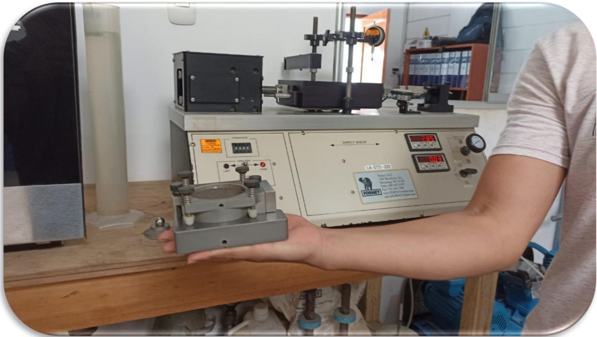
Figura 16: Ensayo de corte directo
