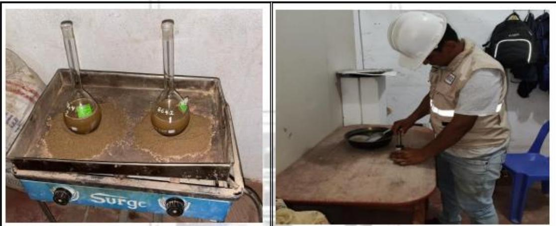
Fotos nº 05-06: En las imágenes podemos observar la realización del ensayo el peso específico
