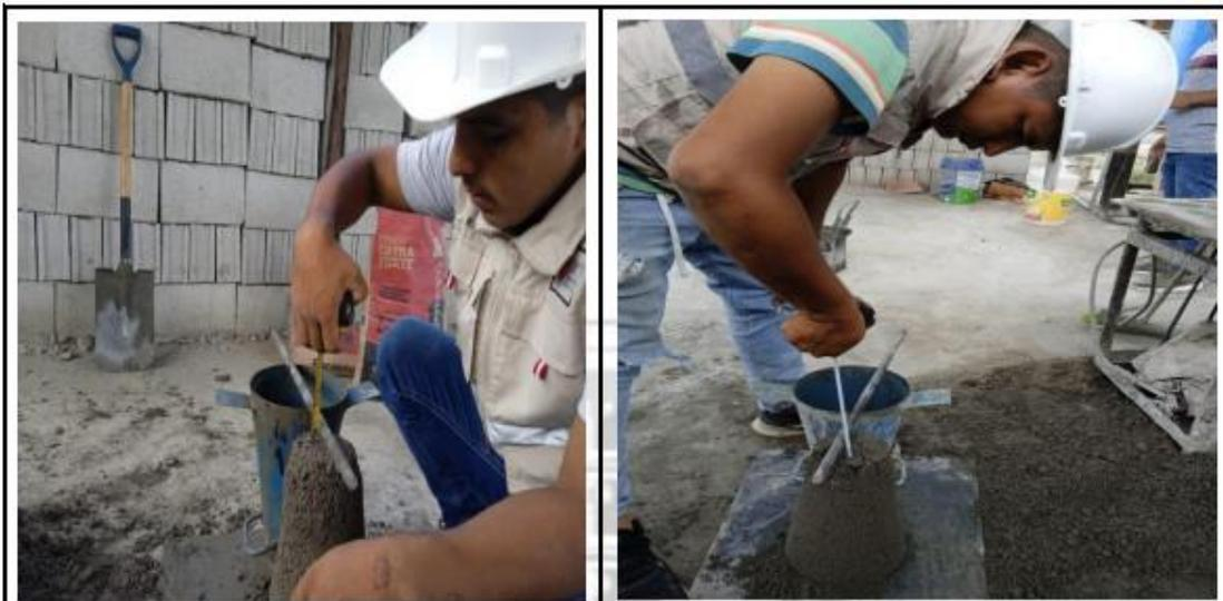
Fotos nº 11-12: En las imágenes podemos observar al personal realizando la prueba de asentamiento para los diseños de Mezclas.
