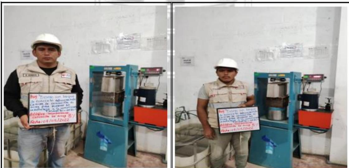
Fotos nº 13-14: En las imágenes podemos observar la resistencia a la compresión axial de los testigos de concreto
