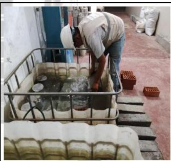
Fotos nº 19-20: En las imágenes podemos observar la absorción de los bloques de concreto
