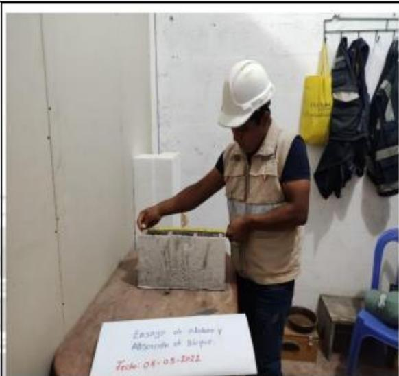
Fotos nº 17-18: En las imágenes podemos observar el dimensionamiento de los bloques de concreto
