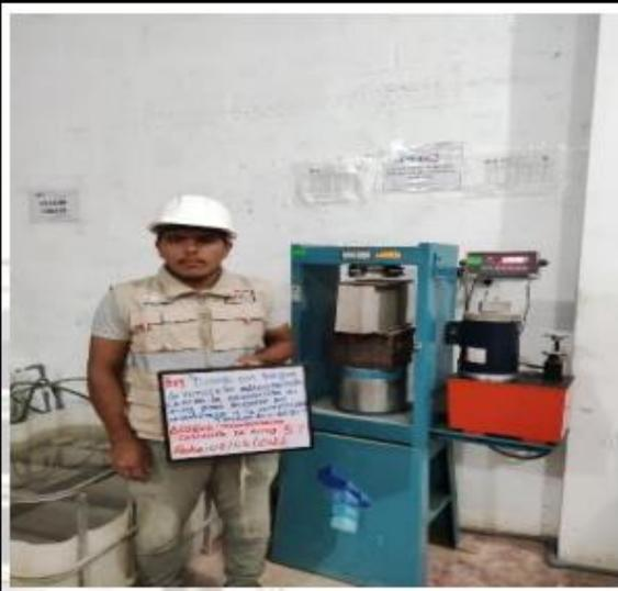
Fotos nº 15-16: En las imágenes podemos observar la resistencia a la compresión axial de los testigos de concreto
