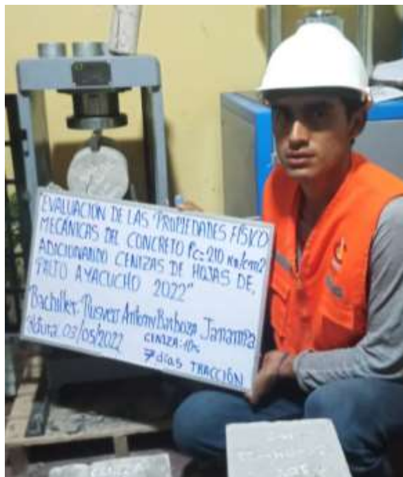
Figura 55. Ensayo de resistencia a tracción a 7 días de curado.
