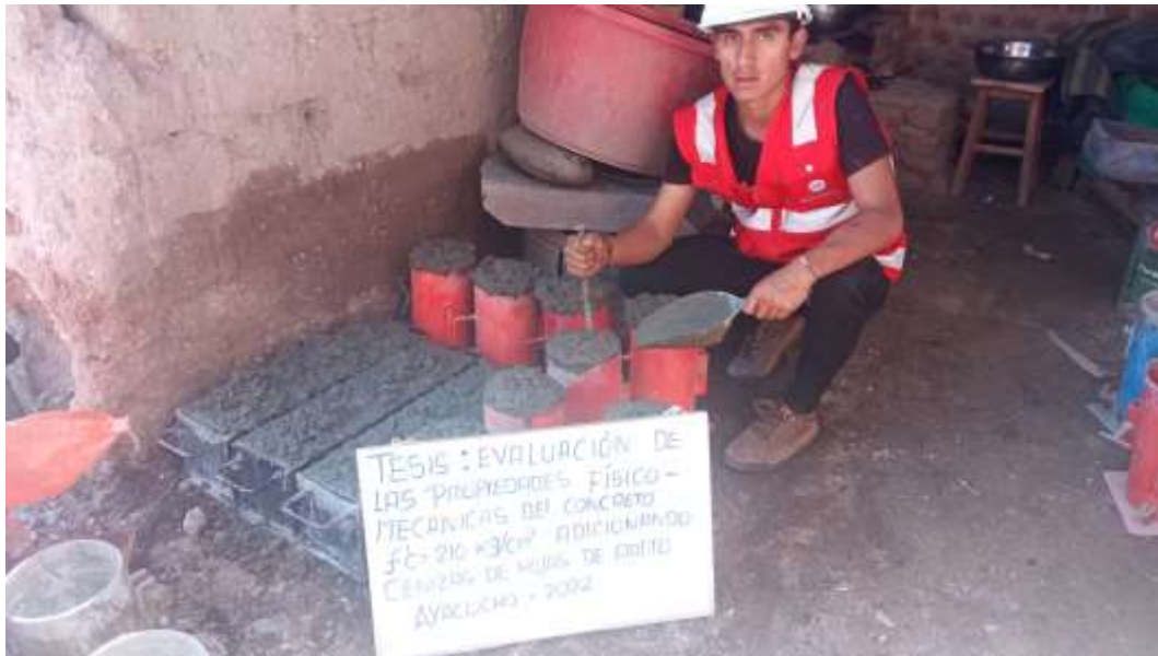
Preparación de briquetas cilíndricas y vigas.
