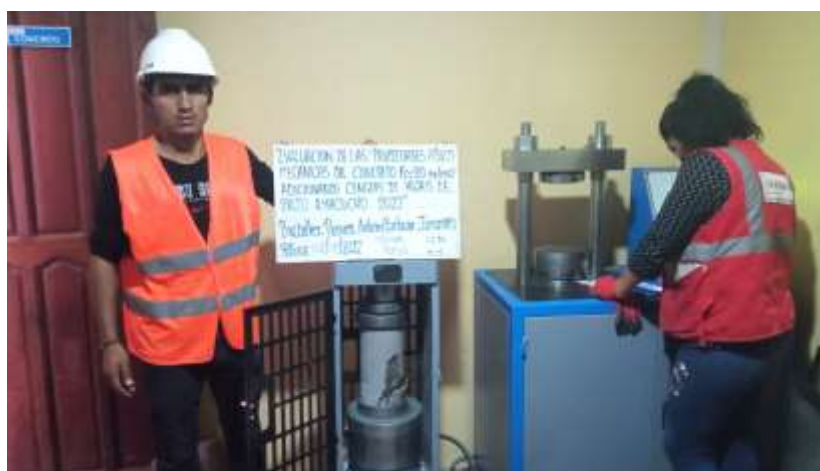
Figura 48. Ensayo de resistencia a compresión a 7 días de curado.
