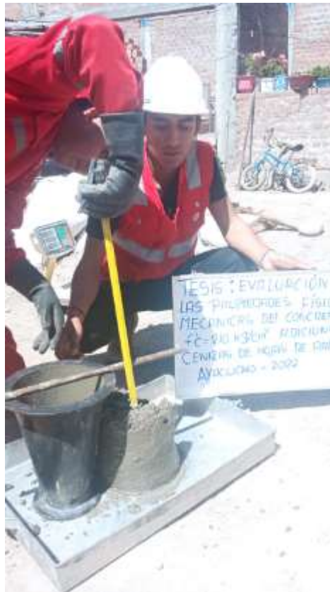
Figura 8. Asentamiento del concreto
