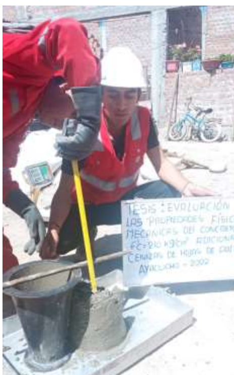
Figura 43. Ensayo de asentamiento utilizando el cono de Abrams
