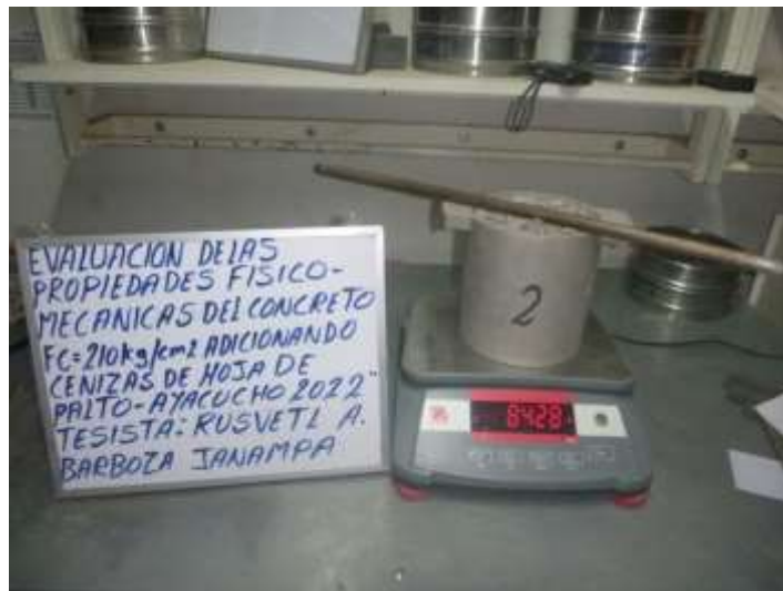
Figura 37. Peso unitario suelto y compactado para el agregado grueso
