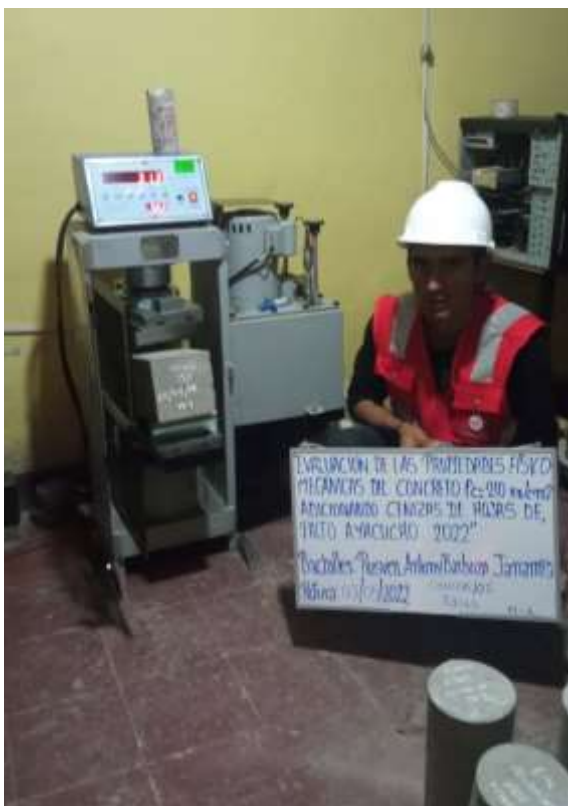
Figura 61. Ensayo de resistencia a flexión a 7 días de curado
