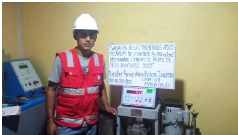
Figura 52. ensayo de resistencia a compresión a 28 días de curado.
