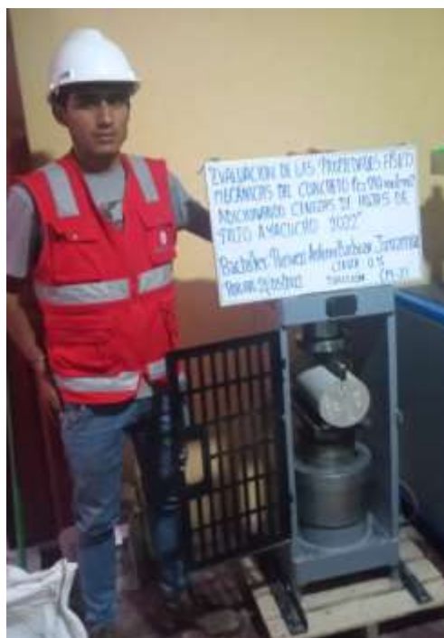
Figura 58. Ensayo de resistencia a tracción 28 días
