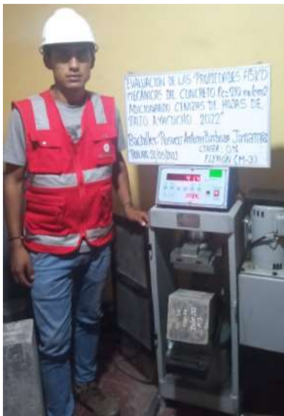
Figura 66. Ensayo de resistencia a flexión.
