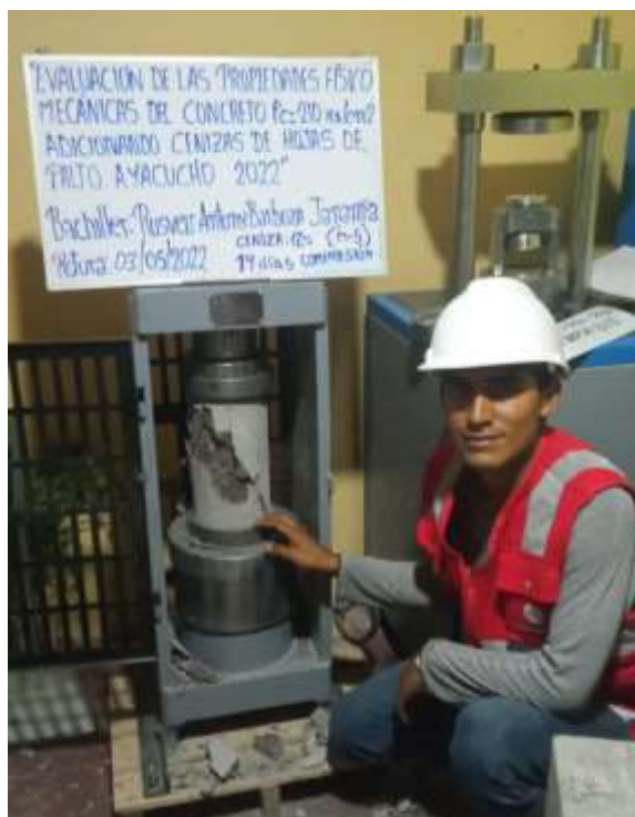
Figura 50. Ensayo de resistencia a compresión a 14 días de curado
