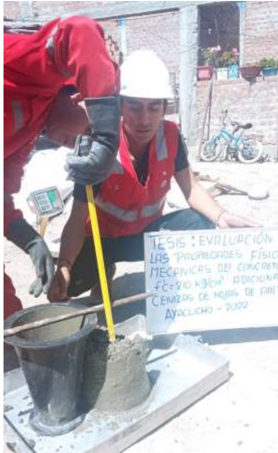
Ensayo de slump.
