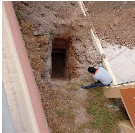
*Figura 52:* Se advierte que dicha calicata solo tiene un solo estrato.
