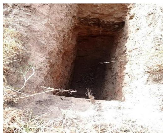
*Figura 44:* Se puede apreciar que dicha calicata está conformada por un solo estrato.
