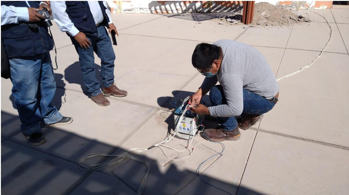
*Figura 39:* Se aprecia la realización del ensayo de la tomografía eléctrica 2D de forma longitudinal de las áreas ocupadas de la I.E.
