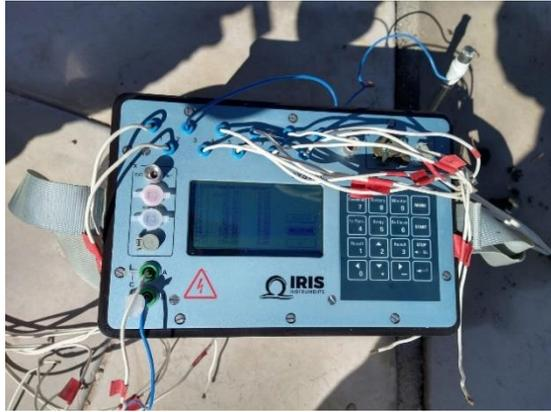
*Figura 37:* Se aprecia el equipo con el cual se realizó la tomografía eléctrica resistiva 2D en las áreas ocupadas de la I.E Señor de los Milagros.
