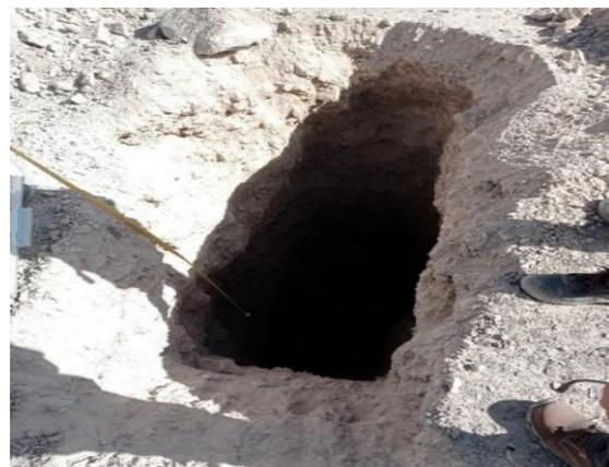
*Figura 50:* Se advierte que dicha calicata solo tiene un solo estrato.
