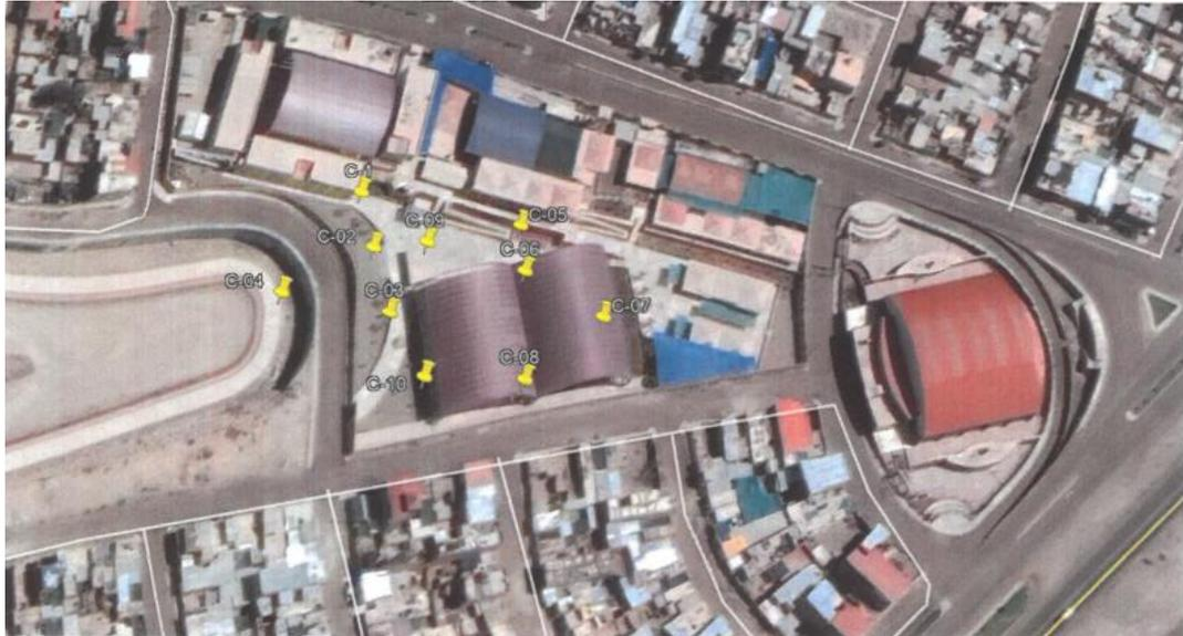
**Figura 7:** Ubicación de los lugares donde se realizará la exploración del suelo a través de calicatas
