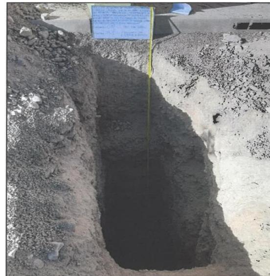
*Figura 62:* Se pudo advertir que en la calicata se observó dos estratos en la cual en el segundo estrato que tienen una profundidad de 1.00 metro a los 3.00 metros está conformado por relleno no controlado.
