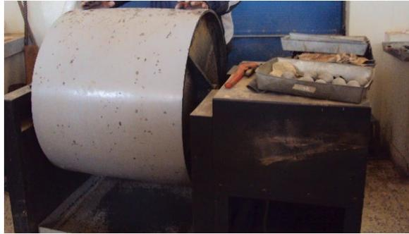
Figura 12: Ejecucion del ensayo abrasión los ángeles
