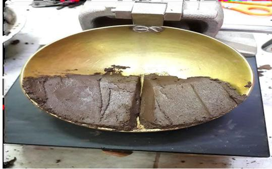
Figura 10: Ejecucion del ensayo de limite liquido
