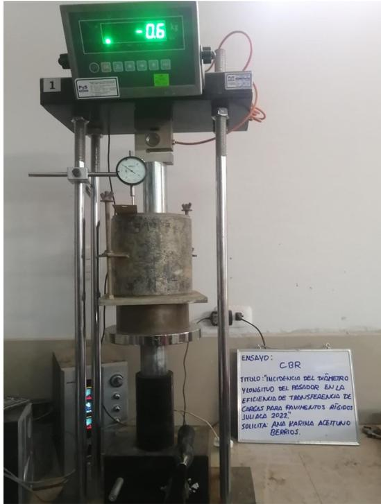
Figura 8: Ejecucion del ensayo de CBR para suelo natural
