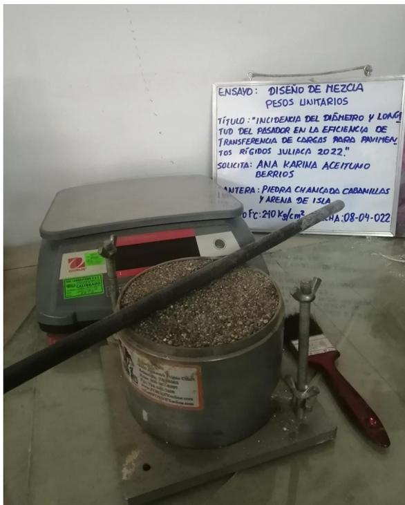
Figura 16: Ejecucion de los ensayos de peso especifico y peso unitario
