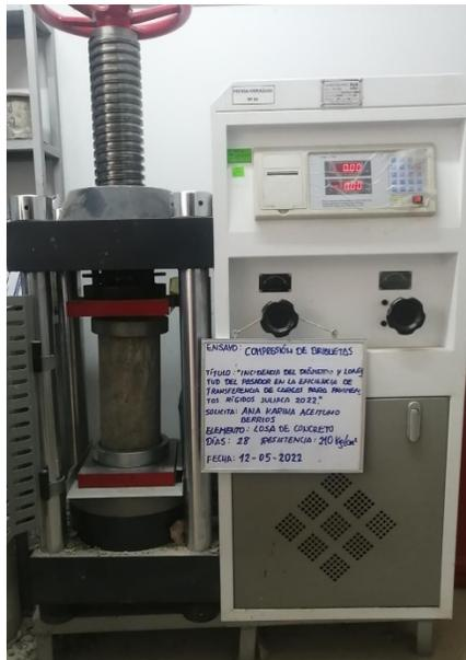
Figura 18: Resistencia a la compresion
