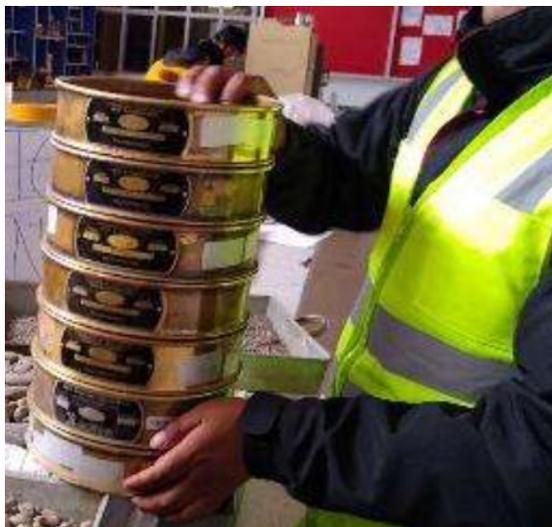
Figura 9: Ejecucion del ensayo de granulometría
