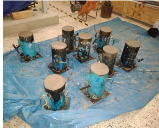
Figura 17: Moldeo de briquetas
