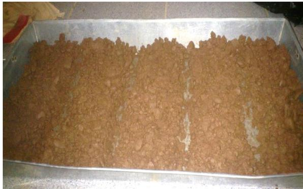
Figura 13: Ejecucion del ensayo Proctor modificado
