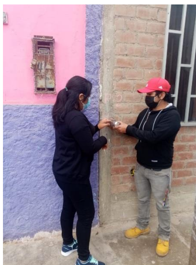
Figura 32 Realización de prueba de esclerómetro en columna, como P 2.
