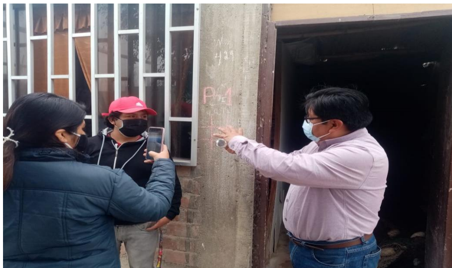
Figura 31 Realización de prueba de esclerómetro en viga, como P 1.
