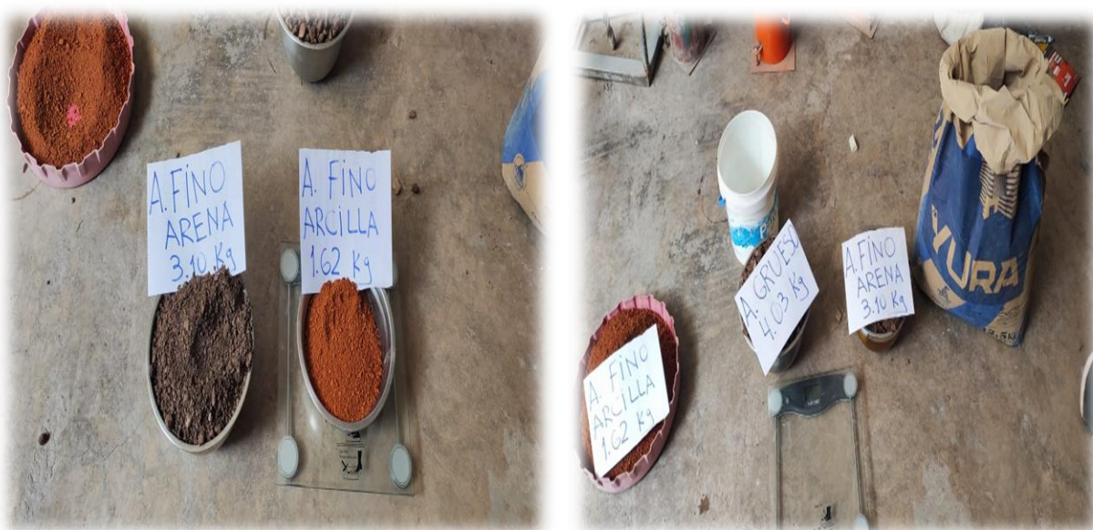
FOTO N° 06 Peso de residuos de ladrillo y arena para su remplazo al 15 y 25 %
