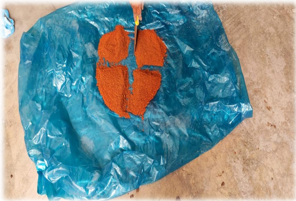
FOTO N°04 Muestra por cuarteo para la mezcla al 15%y 25%
