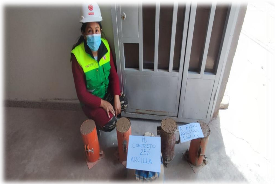
FOTO N° 11 Briquetas realizadas según diseño de mezcla incluido residuos de ladrillo
