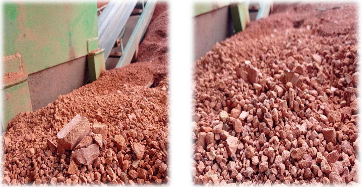
FOTO N° 04 Material que genera la maquina chancadora (LATESAN)
