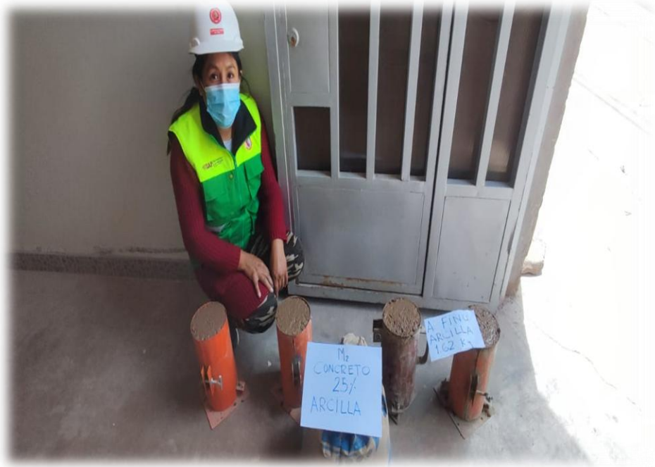
FOTOS N° 10 Briquetas según dosificación al 25% de residuos de ladrillo
