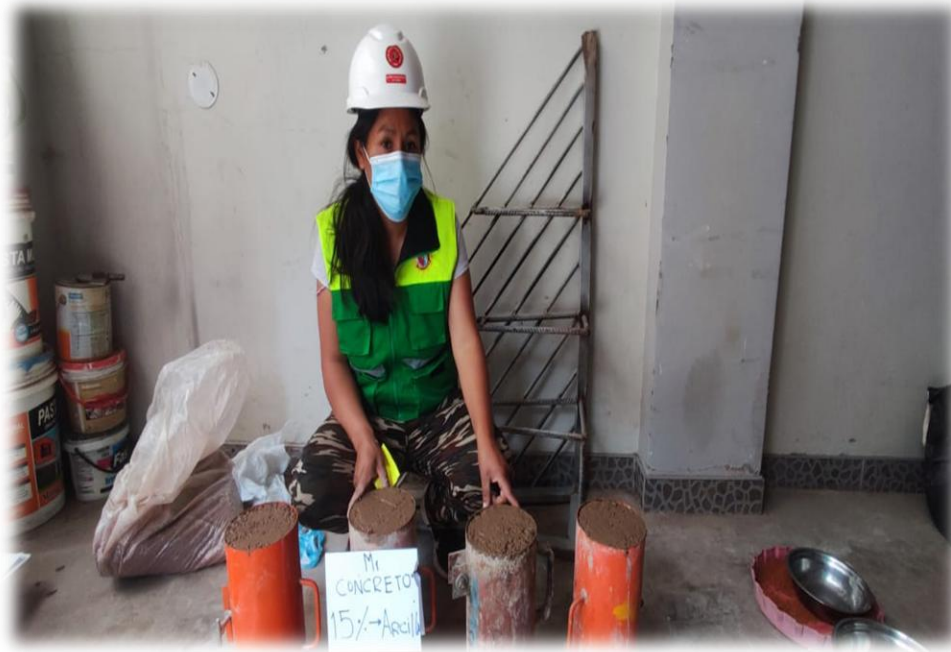
FOTO N° 09 Briquetas según dosificación al 15% de residuos de ladrillo
