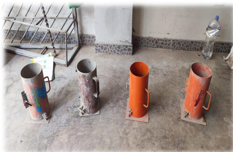
FOTO N° 05 Briqueteras que serán usadas en las pruebas
