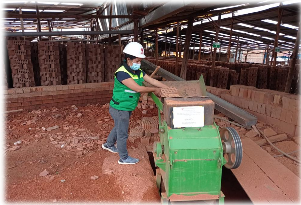
FOTO N° 02 Maquina chancadora de residuos de ladrillo (LATESAN)
