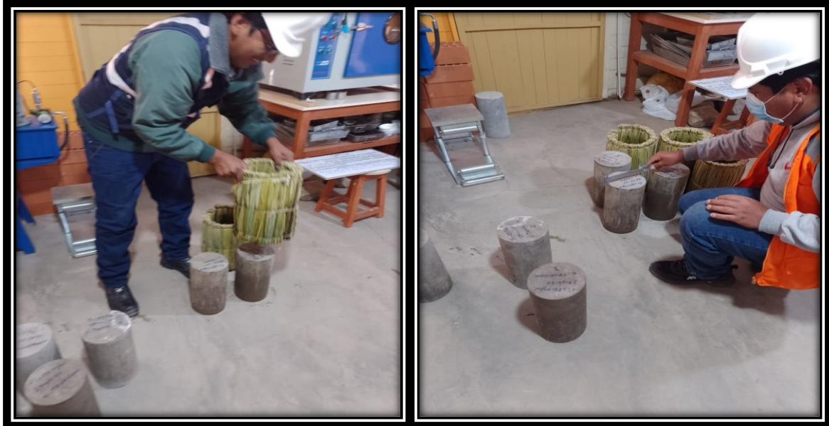
Figura 17. Retirado de la totora para el ensayo y medición del espécimen
