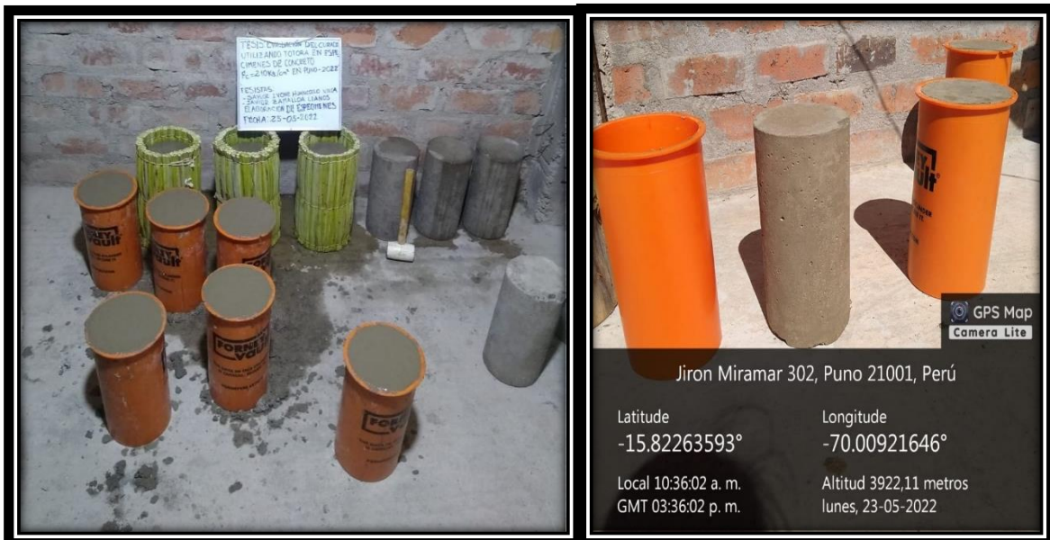
Figura 12. Colocado del concreto en moldes de PVC
