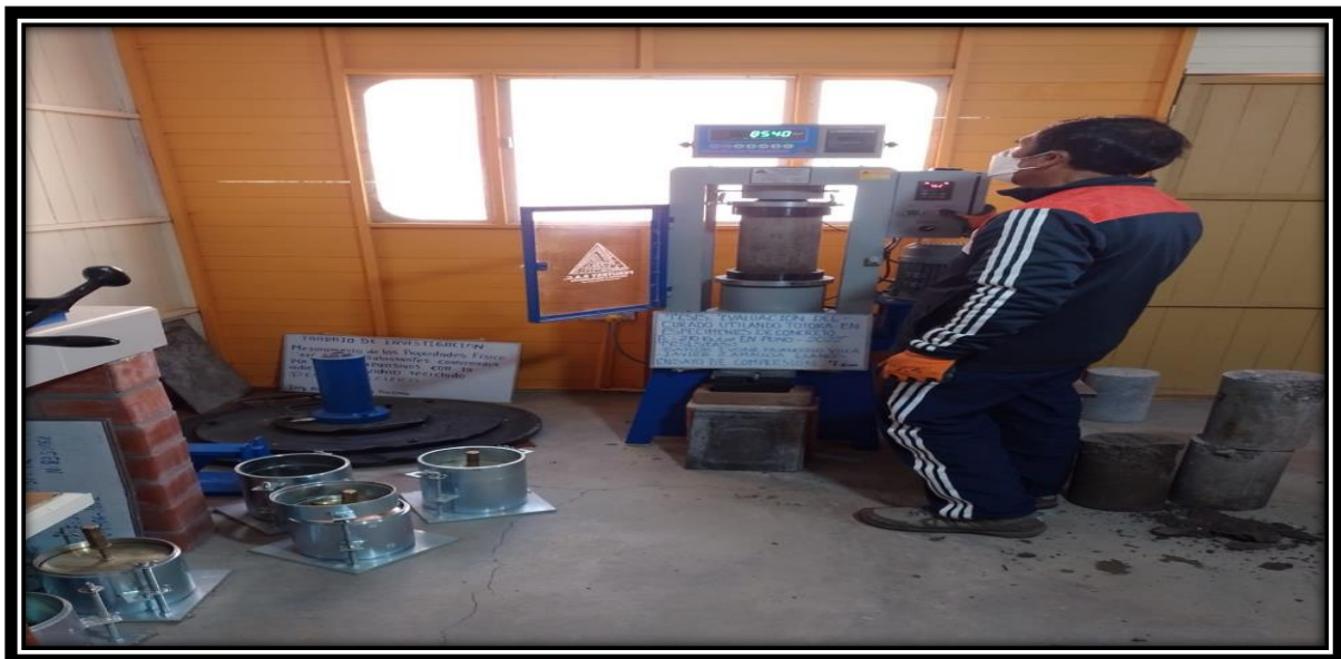
Figura 18. Rotura del espécimen en la maquina compresora
