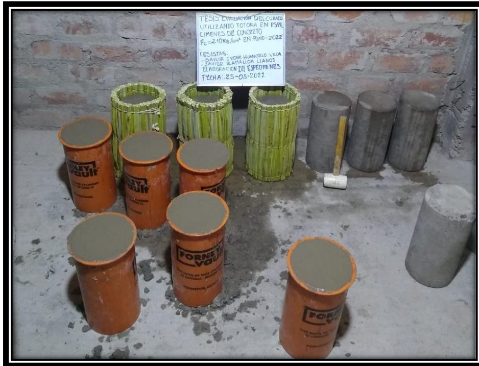
Briquetas culminadas de llenar y posterior enrasado.
