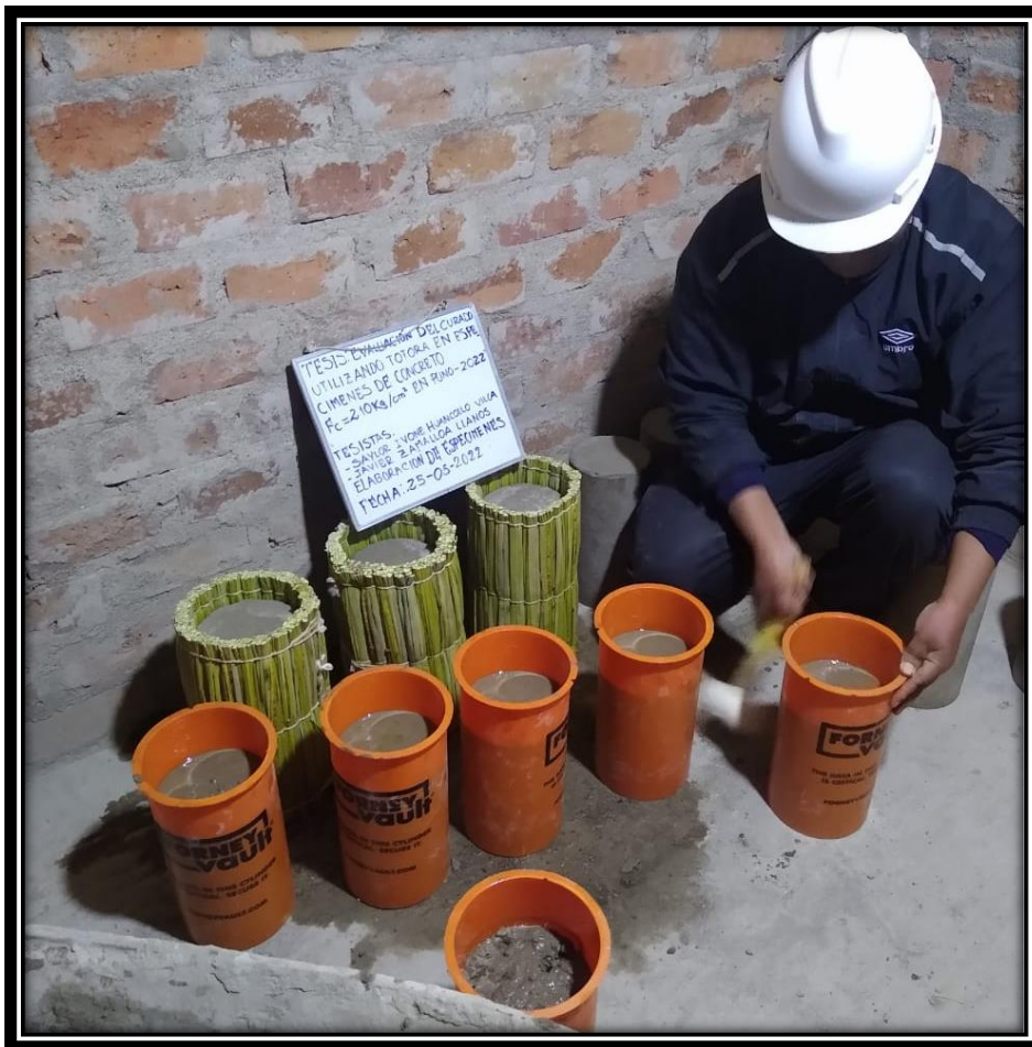
Proceso de llenado de las briqueteras para la obtención de especímenes.
