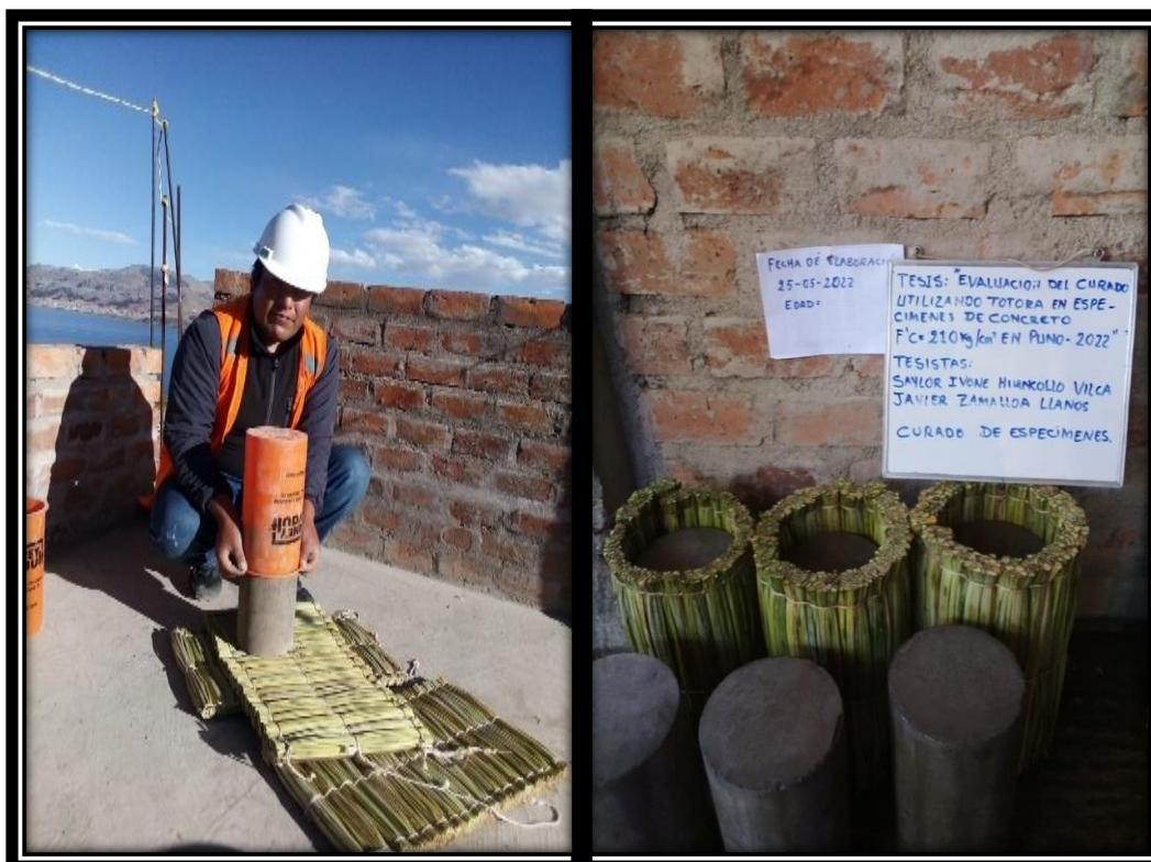
Figura 13. Desmoldado del concreto
