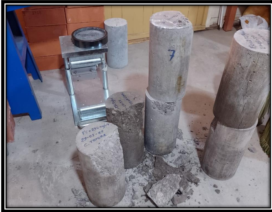
Producto de los especímenes posterior a ser sometidos al ensayo de compresión.
