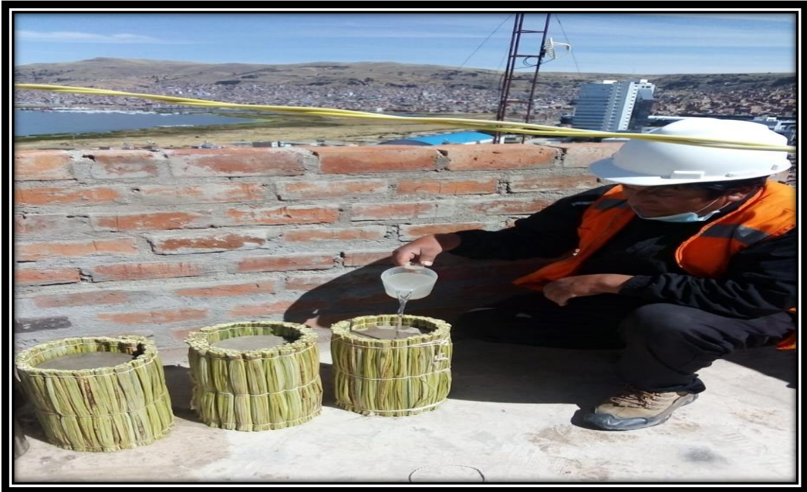
Figura 15. Método de curado de concreto con totora
