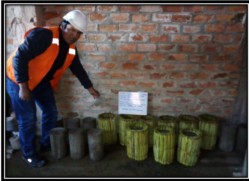
Figura 24. Curado de los especímenes con totora, tradicional y patrón
