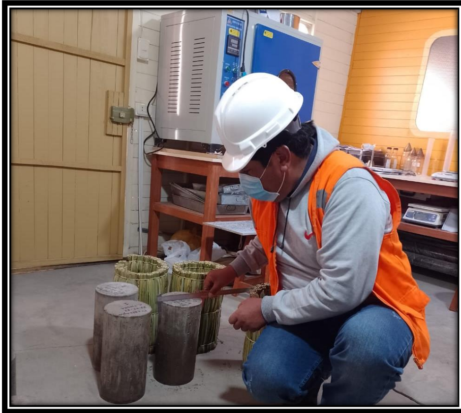
Medidas de las muestras llevadas a laboratorio para realizar el ensayo de compresión.
