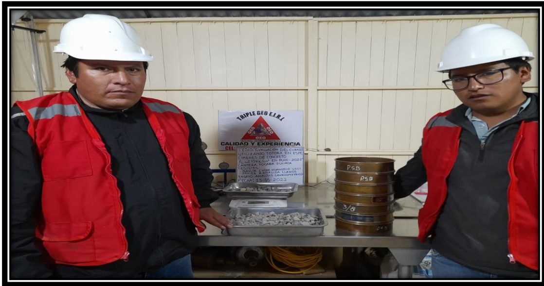
Figura 9. Ensayo de análisis granulométrico en laboratorio
