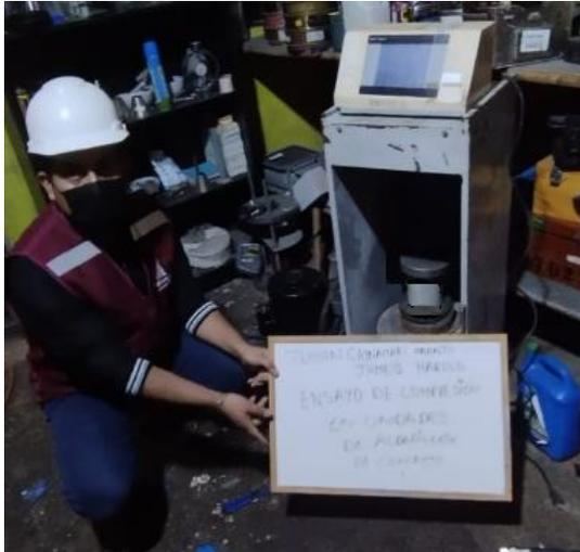
**Figura 29:** ensayo de bloques de concreto
