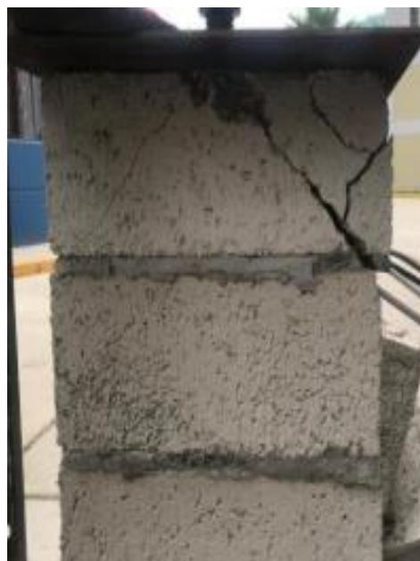
**Figura 22:** Ensayo de compresión pilas
