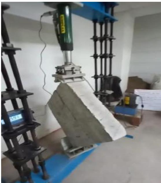
**Figura 26:** Ensayo de murete
