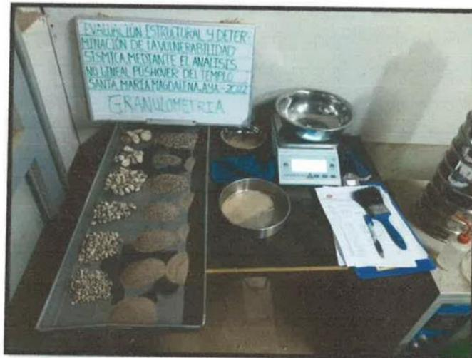
Fotografía N°03.- En la fotografía se observa el material de la calicata C-01, realizado a través del ensayo de granulometría.
