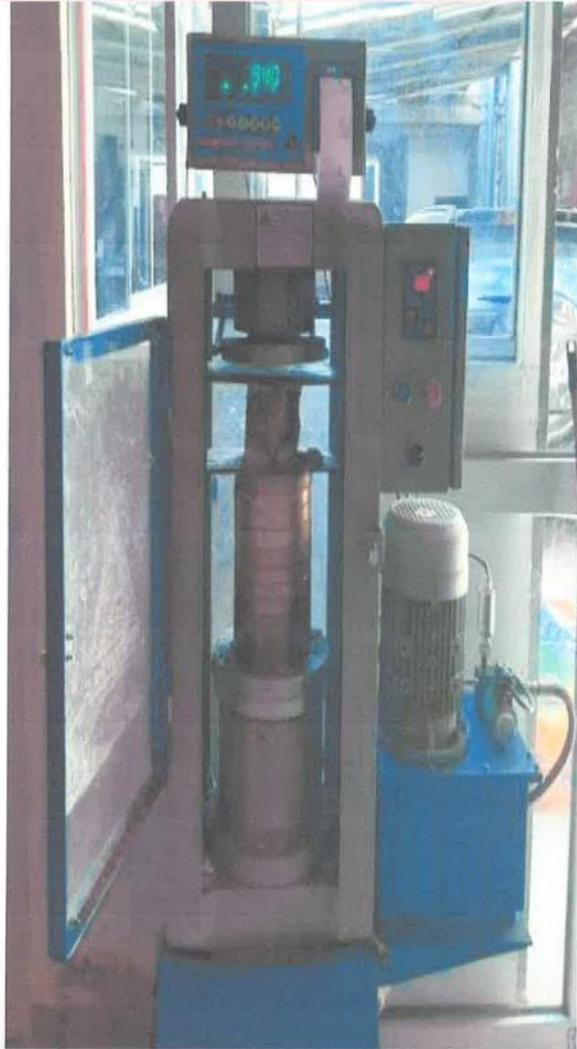
Fotografía N°04.- Muestra número 6 sometido a prueba de resistencia a la compresión.
