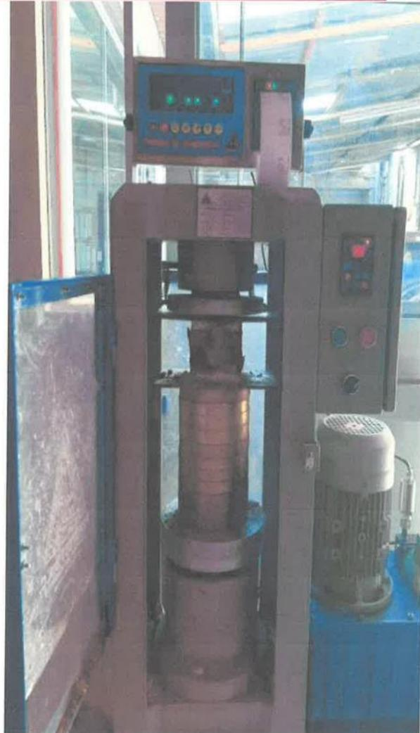
Fotografía N°02.- Muestra número 1 sometido a prueba de resistencia a la compresión.
