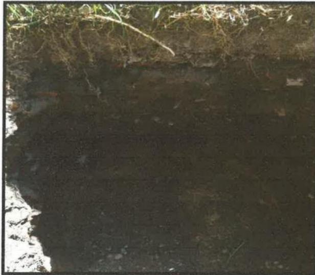
Fotografía N°01.- En la fotografía correspondiente a la Calicata C-01, se observa el estrato E-1, la presencia de un suelo orgánico con presencia de raíces y en el estrato E-02 se observa el material consolidado de limo y arena.
