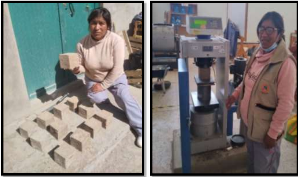
Figura 39. Secado de muestra y ensayo de resistencia a compresión de cubos de adobes
