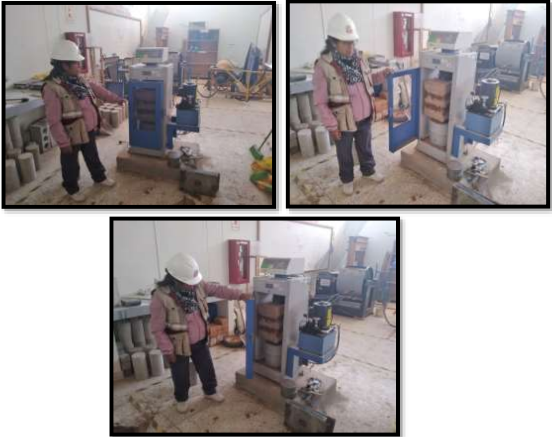
Figura 41. Ensayo de resistencia a la compresión en pilas
