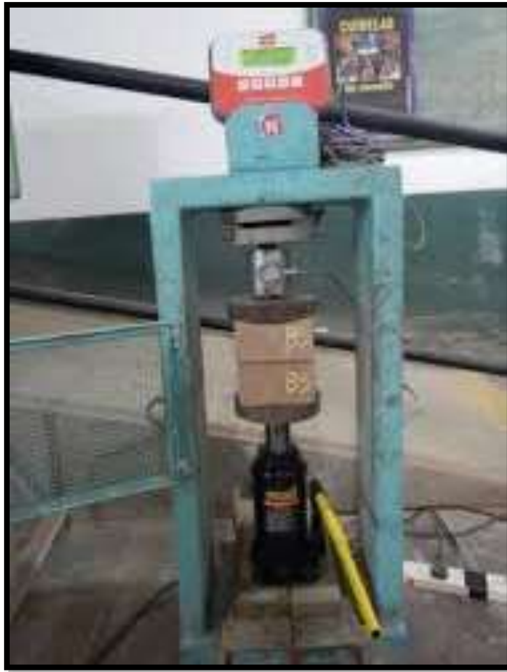
Figura 10. Fotografía de ensayo de resistencia a compresión
