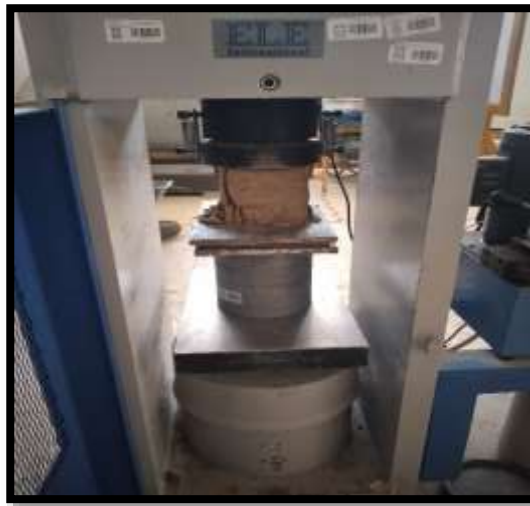
Figura 40. Rotura de adobe estabilizado
