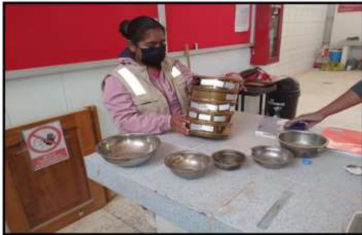
Figura 27. Realizando la granulometría de la muestra en laboratorio
