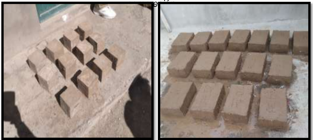
Figura 38. Producción de adobes para resistencia de absorción y
