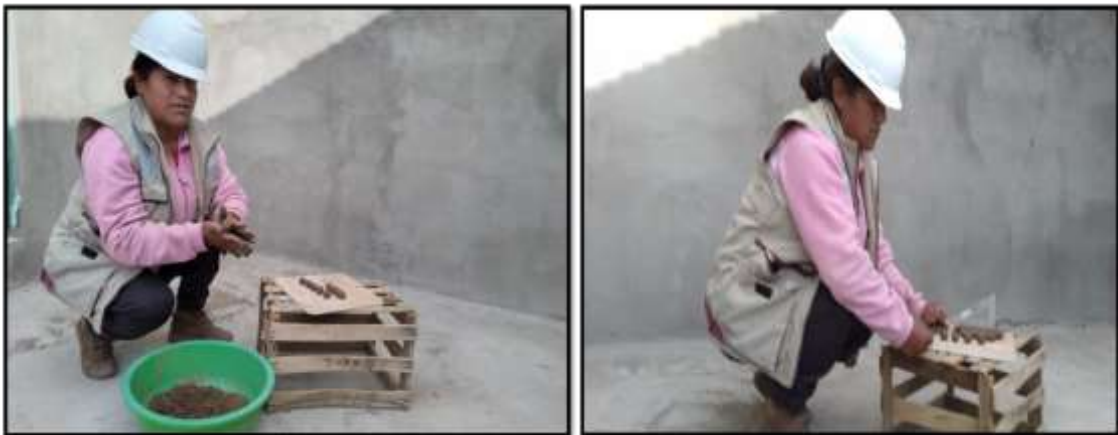
Figura 25. Elaboración y medición de los rollitos para la prueba.
