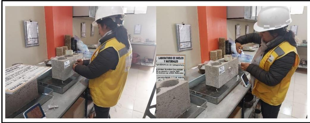
*Figura 39:* Instalación del termómetro digital.
