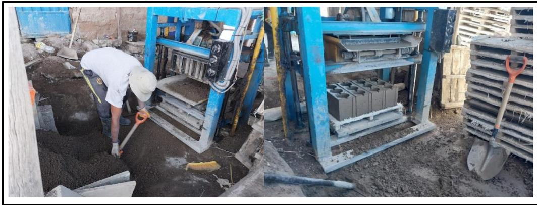
*Figura 31:* Elaboración de bloques de concreto.
