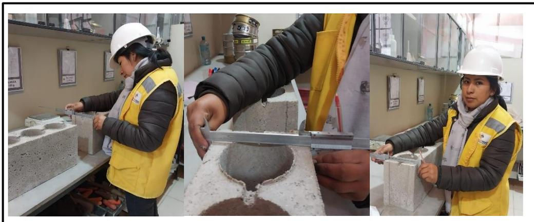
*Figura 34:* Ensayo de variación dimensional.
