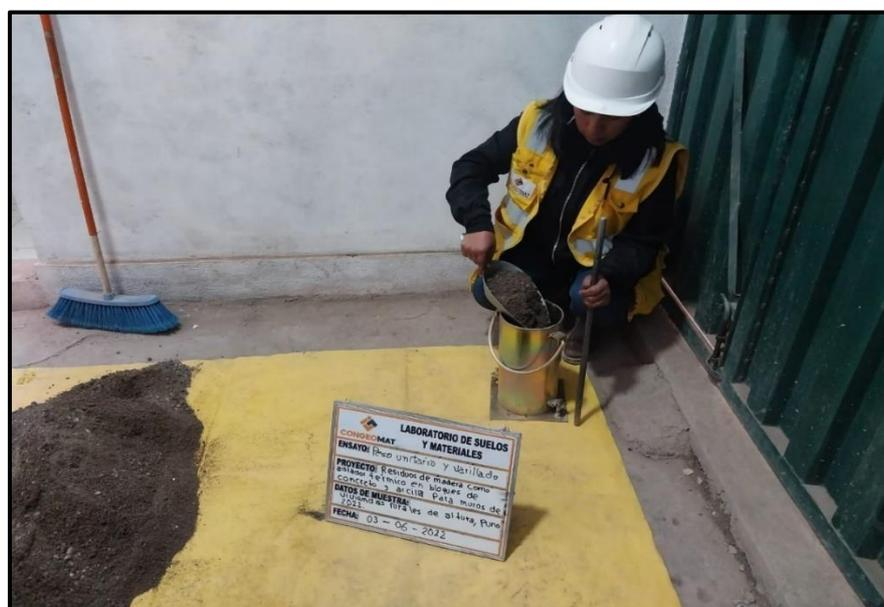
Figura 23: Procedimiento del ensayo de peso unitario del agregado.
