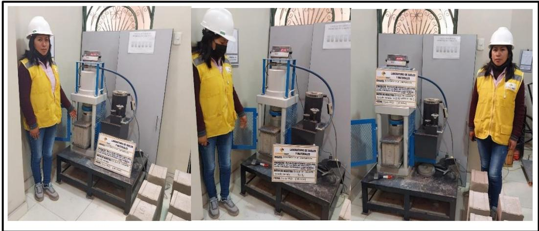
*Figura 33:* Ensayo de resistencia a la compresión.
