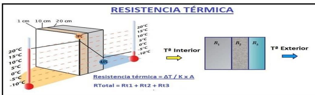
Figura 15. Resistencia térmica.
