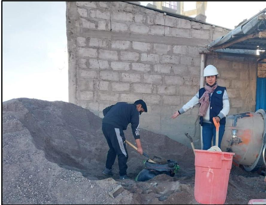
*Figura 19:* Obtención de material por cuarteo.
