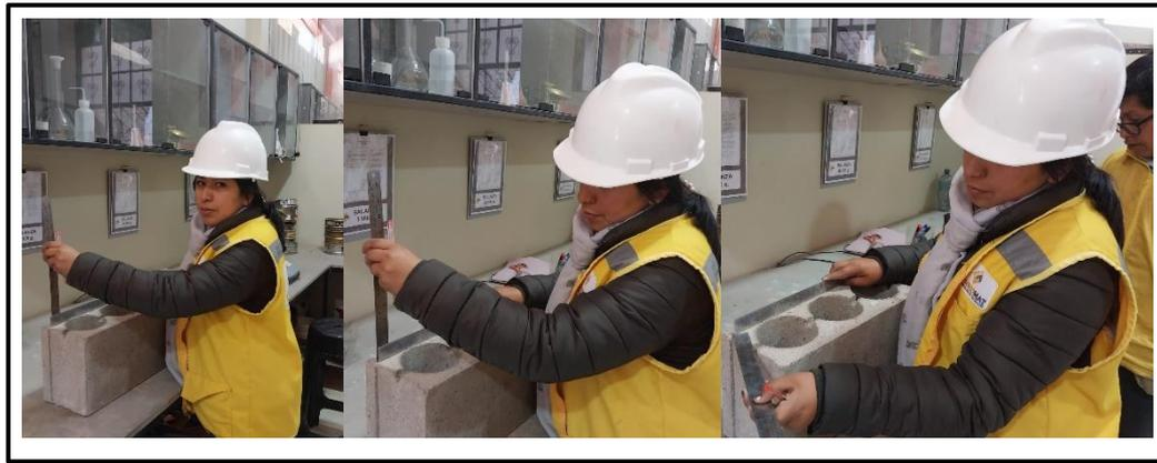
*Figura 35: Ensayo de alabeo.*
