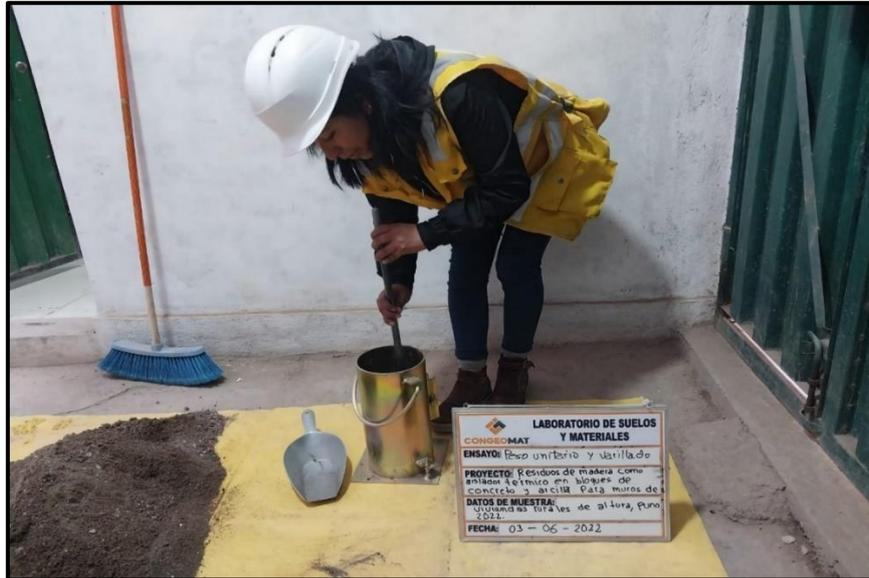
Figura 24: Procedimiento del ensayo de peso unitario compactado.
