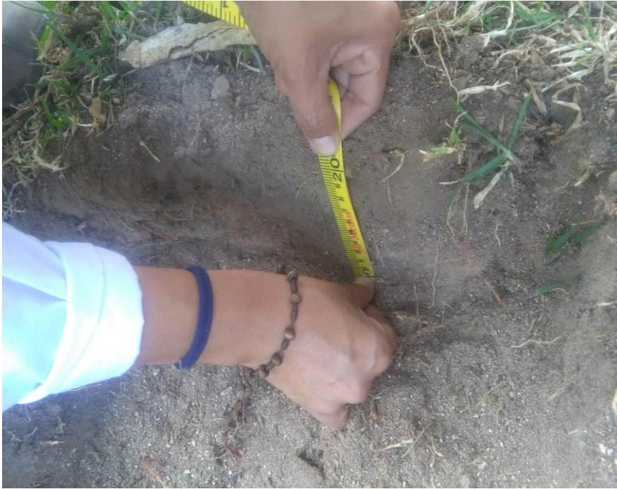
Figura N° 16, medición de la profundidad de la calicata
