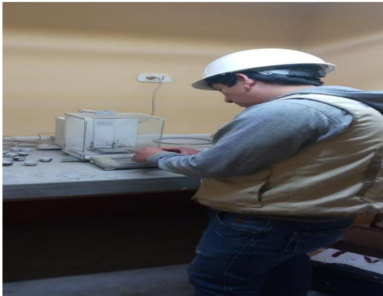
IMAGEN 12: PESADO DE MUESTRAS PARA LL-LP-IP
