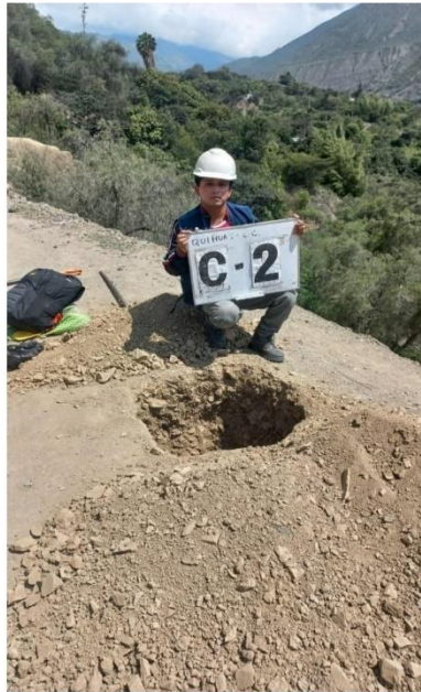
VISTA PANORÁMICA DE LA CALICATA C-2 DONDE SE PROYECTO LA LINEA DE CONDUCCION - CASERIO QUIHUAY
