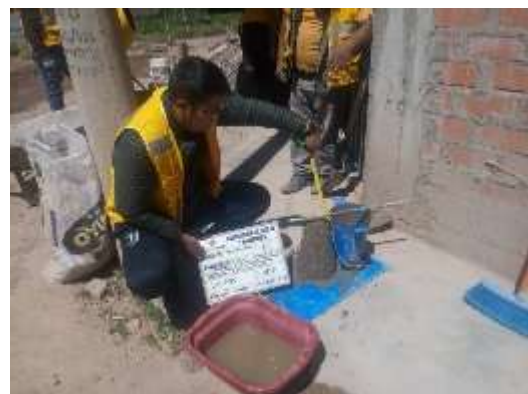
Figura 6: medición del slump en mezcla de concreto agregando aserrín al 5%
