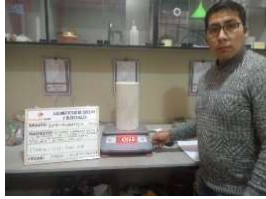
Figura 8: pesado de briquetas de concreto agregando 5% de aserrín
