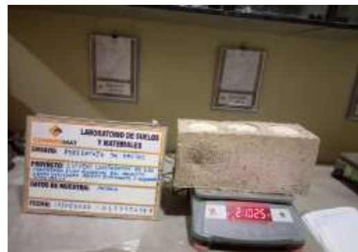
Figura 12: porcentaje de vacíos de los bloques de concreto agregando aditivo espumante
