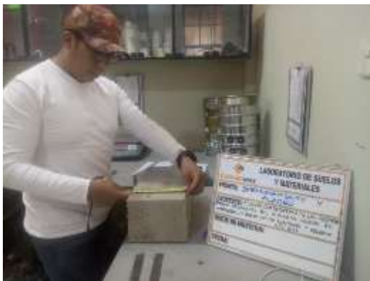
Figura 11: medición del dimensionamiento y alabeo de bloques de concreto para muros no portantes agregando aserrín 15%
