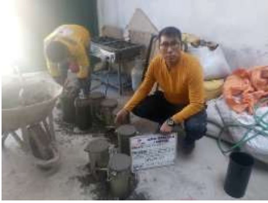
Figura 7: preparación de briquetas de concreto agregando aditivo espumante 0.10%
