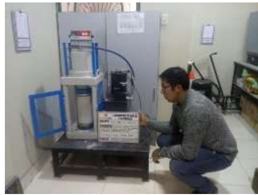
Figura 10: rotura de briquetas de muestra patrón f_c=100\text{kg/cm}^2
