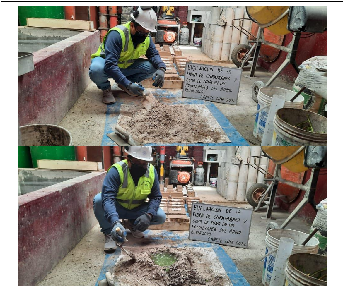
mezclado de los materiales para la elaboración de los adobes
