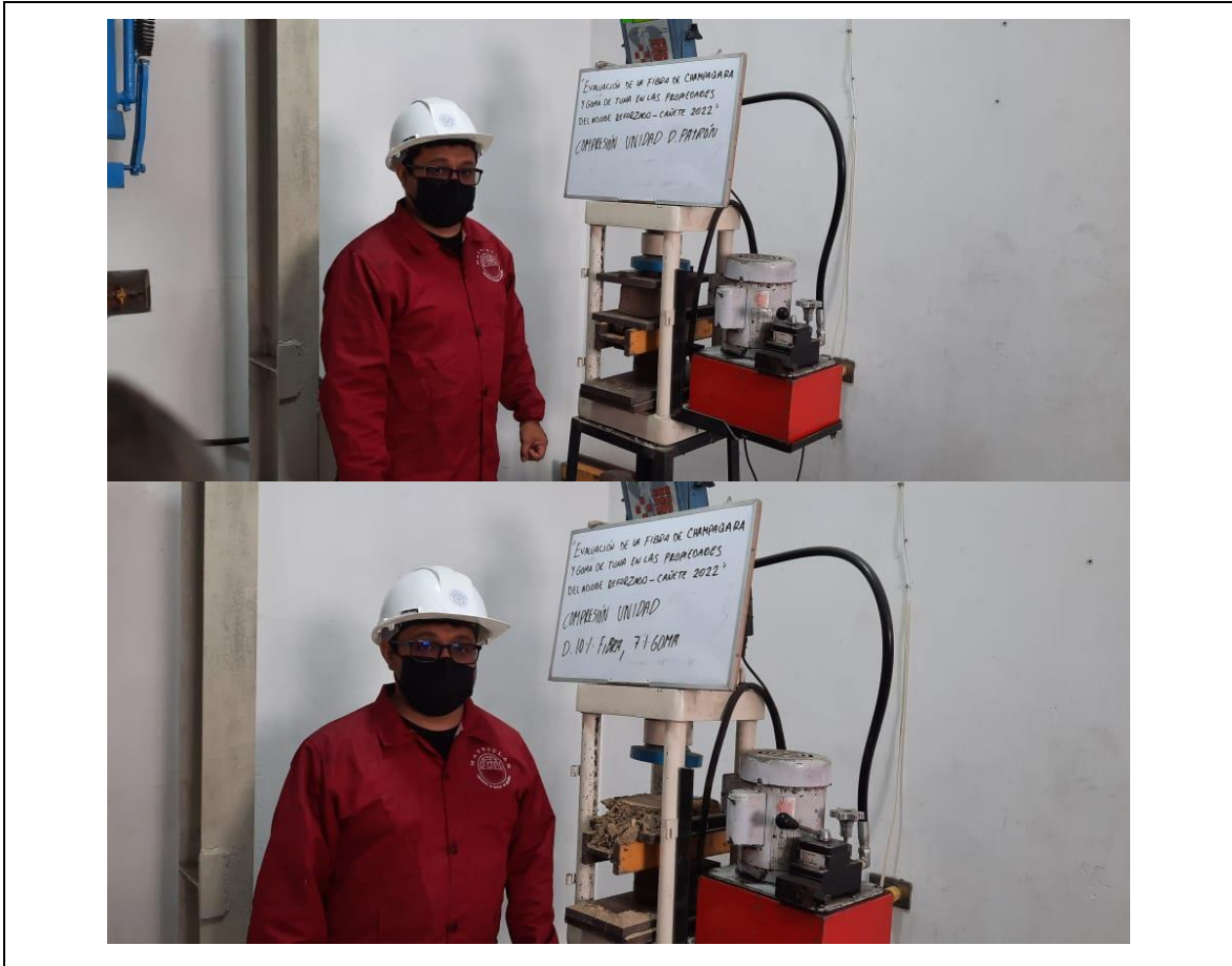
Ensayos de la resistencia a la compresión de los adobes
