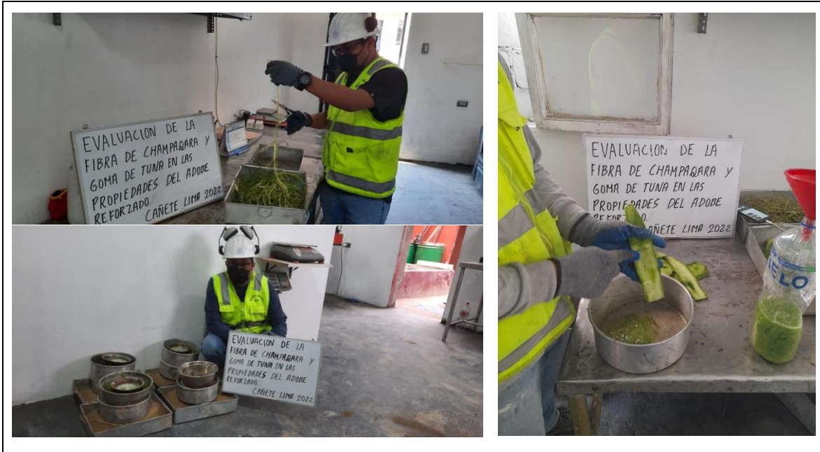
Obtención de la fibra de champaqara y goma de tuna para el diseño de mezcla
