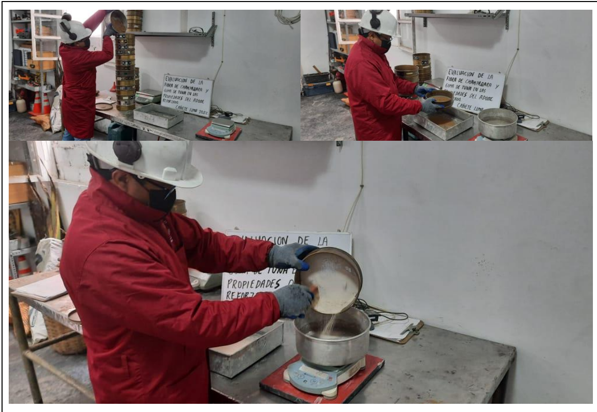
Tamizado de la muestra para el análisis granulométrico
