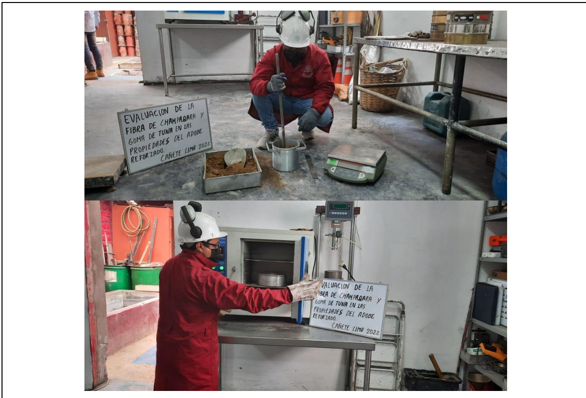
Muestra para el análisis de límites de consistencia
