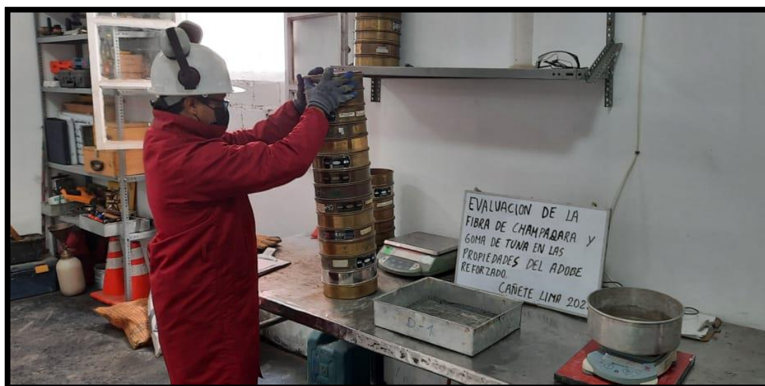
Figura 10. Tamizado para el análisis granulométrico.
