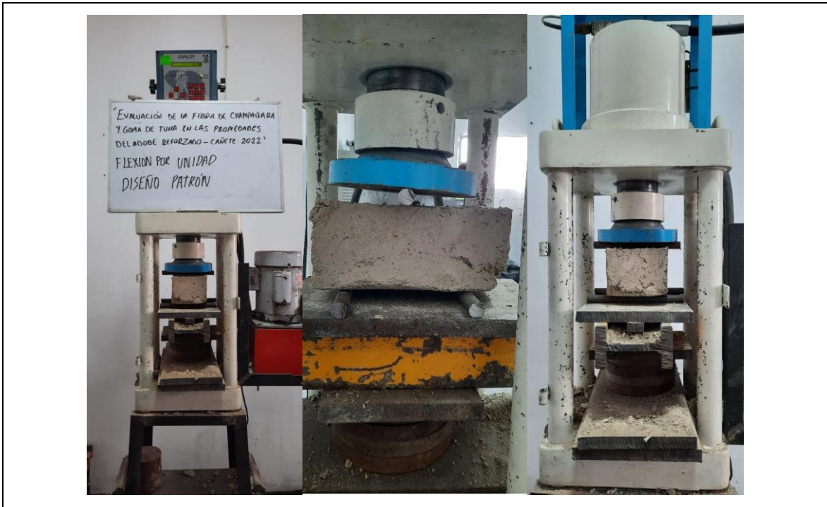
Ensayo de la resistencia a la flexión de los adobes
